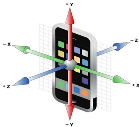
Conceptualmente, un sensor de aceleración determina la aceleración que se aplica a un dispositivo (A) mediante la medición de las fuerzas que se aplican sobre el propio sensor (F) usando la siguiente relación:
