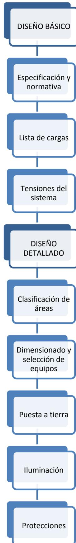
**Figura 1. Bases de diseño.**
