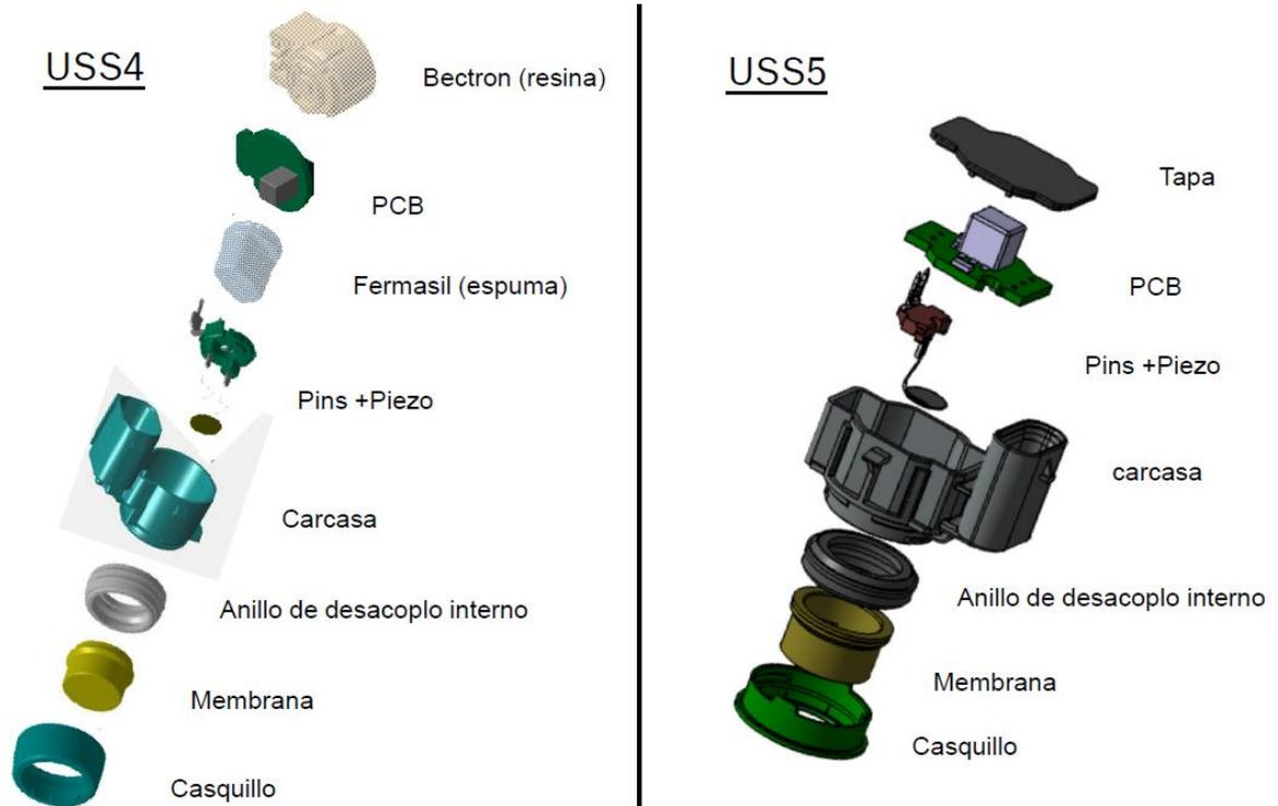
**Figura 11. Diferencias entre el diseño del USS4 y USS5**
