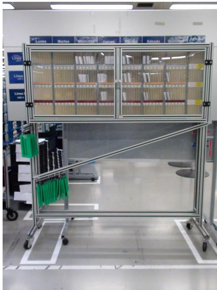
**Figura 49. Tablero Heijunka y FIFO de producción**
