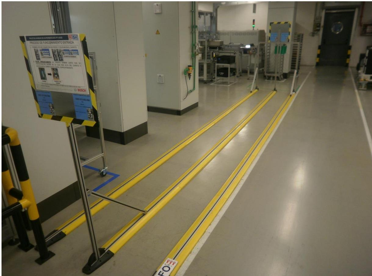
Figura 54. Material y montaje Supermercado Kanban
