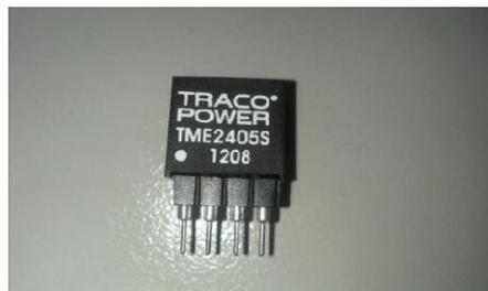
Figura 32 Convertidor DC/DC TME2405
