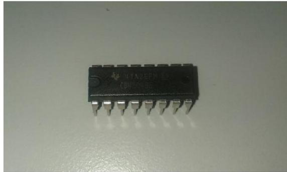
Figura 33. Circuito integrado CD4504B
