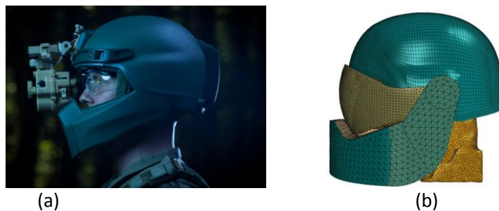
Figura 1. Comparación del casco de combate del programa HEaDS-UP (a) y el modelo numérico (b) desarrollado en este trabajo.
