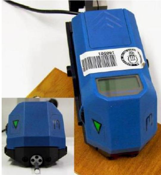
**Figura 3.5. Rugosímetro empleado para obtener el perfil de rugosidad de los cermets ensayados**
