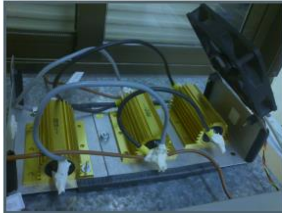
Fig. 4.2 Equipo de ensayos: Resistencias
