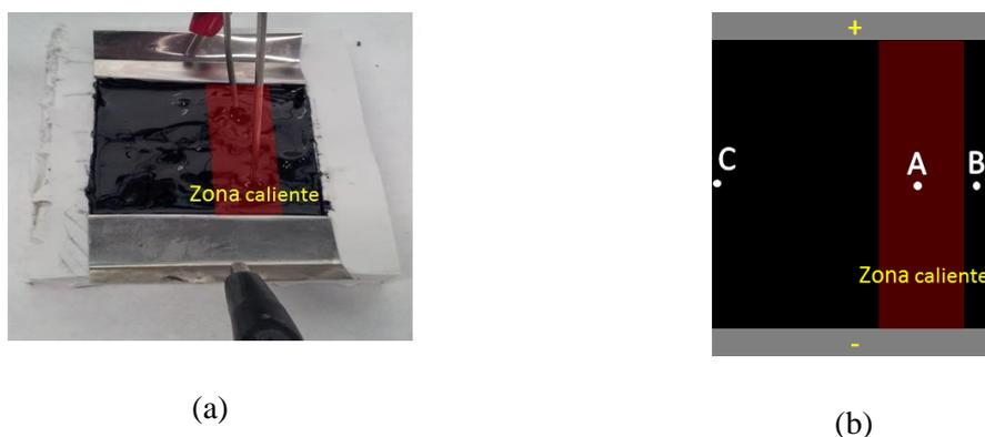
**Figura 47. a) Se muestra la zona caliente que aparece cuando se calienta el material con una pareja de electrodos. b) Esquema de la imagen de la izquierda, donde se muestran los puntos que se han escogido para analizar en el DSC.**
