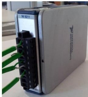
**Figura 12. Módulo de entrada de termopares NATIONAL INSTRUMENTS NI-9211.**
