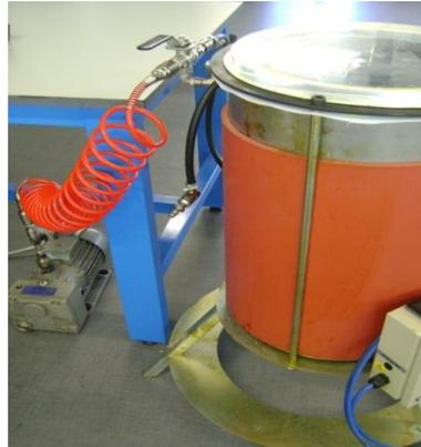
Figura 6. Cámara de desgasificación.
