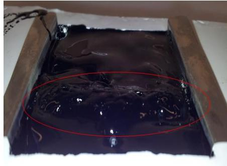
**Figura 31. Muestra que ha sido curada con el sistema de una pareja de electrodos con un calentamiento muy rápido, debido a que el termopar de control se colocó en una zona que no era la más caliente. En rojo se señala la zona en la que aparece una línea de curado**
