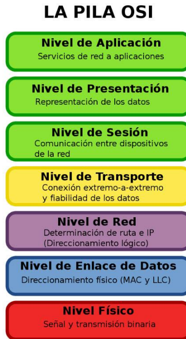
Figura 17: Representación pila OSI. [14]
