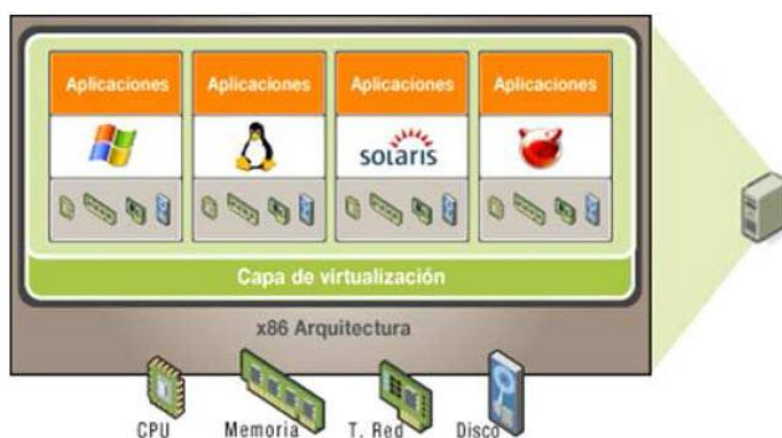
Figura 7: Estructura del concepto de Virtualización. [9]
