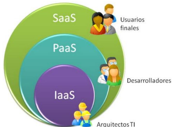
Figura 1: Modelo simplificado Cloud Computing y sus usuarios. [6]
