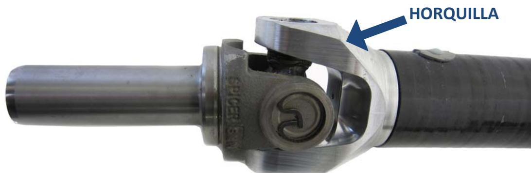
Figura 5.1 Modelo real de la horquilla [48]
