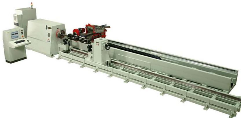
Figura 4.11 Máquina CNC para realizar Filament Winding [37]
