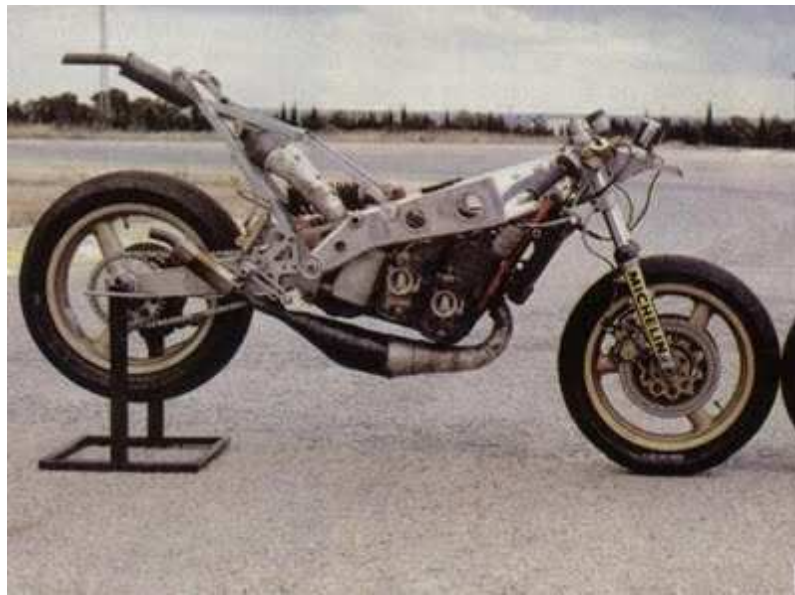
Fig.12: Chasis doble viga de su inventor, Antonio Cobas
