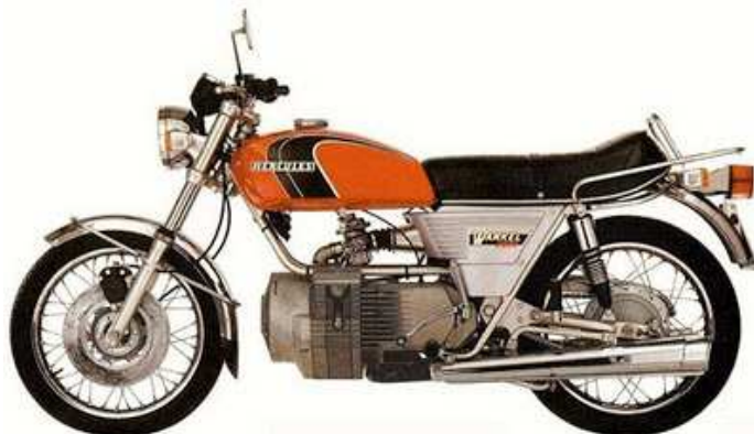
Fig.19: Hercules W200 con motor rotativo Sachs
