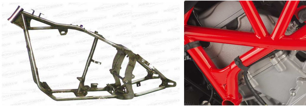
Fig.82: Nervios de refuerzo en columna y anclaje motor
