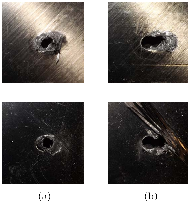
FIGURA 5.28: Estado experimental de las placas con par de apriete \tau = 8Nm y coeficiente de fricción \mu = 0,18 para un desplazamiento de 6mm . (a) Placa superior en contacto con la cabeza del tornillo. (b) Placa inferior en contacto con la tuerca del tornillo.
