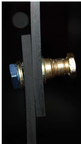
FIGURA 4.7: Efecto de la flexión secundaria.
