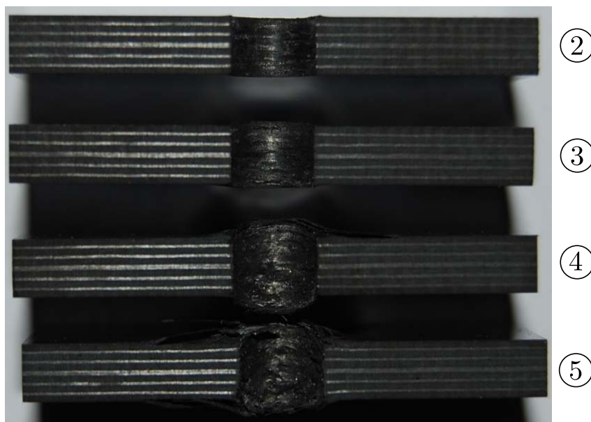
FIGURA 3.24: Sección transversal del laminado mostrando los daños en los puntos 2, 3, 4 y 5 de las figura 3.21.
