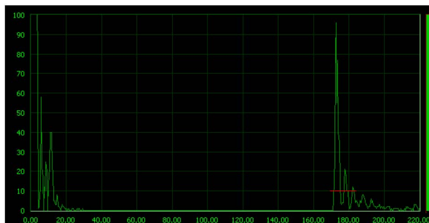
FIGURA 3.15: Señal recibida por el sistema de inspección por ultrasonidos C-Scan sin probeta.
