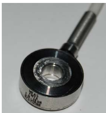
FIGURA 4.15: Célula de carga modelo XFL225D de Measurement Specialties, Inc.
