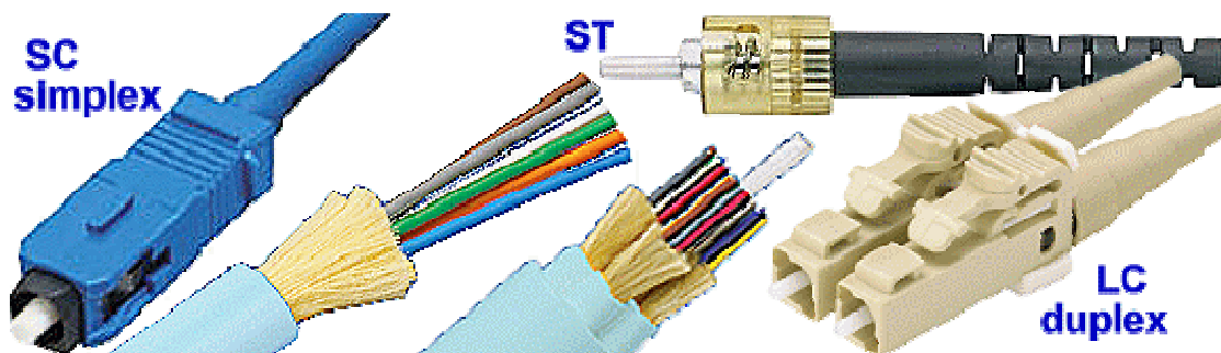
Figura 44 Diferentes tipos de conectores de FO [45]
