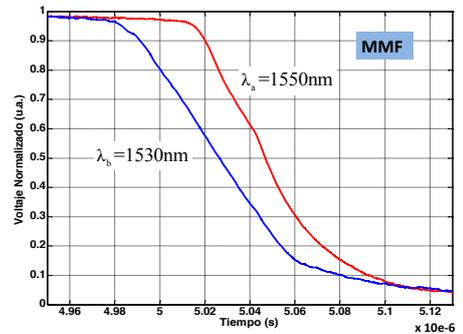
Fig. 5: Transitorio de rotura en enlace de fibra multimodo con: (a)  $L_a=L_b=3050\text{m}$ ,  $\lambda_a=1.31\mu\text{m}$ ,  $\lambda_b=1.55\mu\text{m}$ ; (b)  $L_a=L_b=3050\text{m}$ ,  $\lambda_a=1.53\mu\text{m}$ ,  $\lambda_b=1.55\mu\text{m}$
