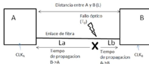
Fig. 1: Esquema del método de localización de fallos en enlaces ópticos dúplex.
