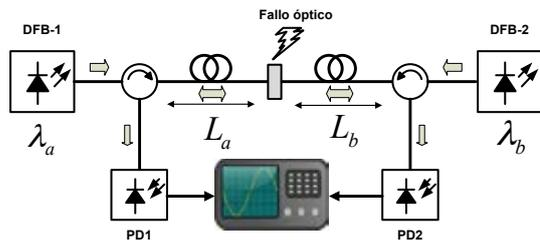
Fig. 2: Montaje experimental.
