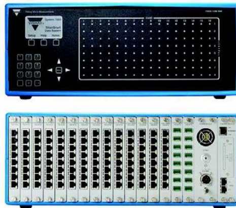
Figura 3-7. Hardware del System 7000
