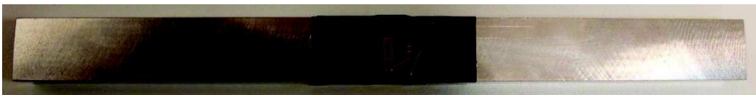
Figura 3-13. Probeta plana para la determinación de las constantes elásticas
