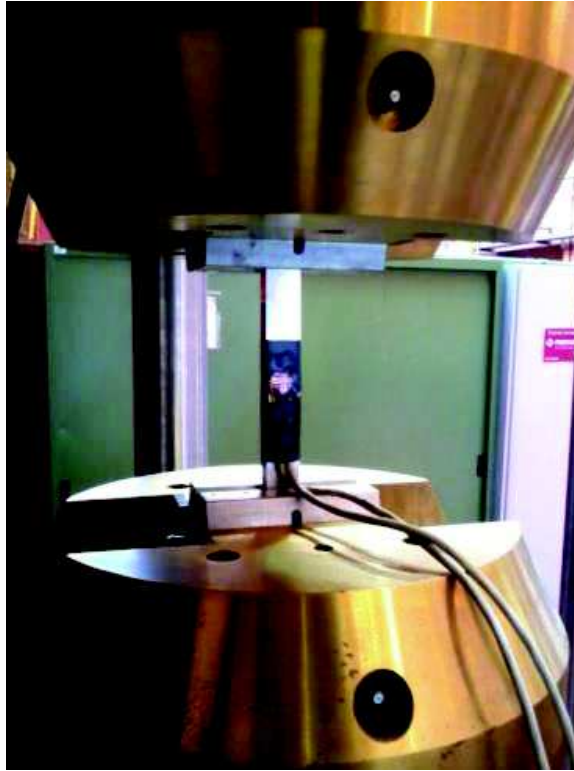
Figura 3-14. Sujeción de la probeta a la máquina de ensayos
