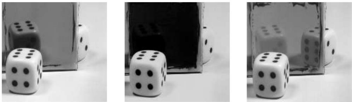
Figura 1.19. Espejo conmutable basado en EC [59]
