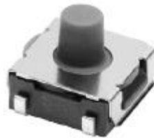
Figura I.7. Pulsador B3SL-1022P empleado
