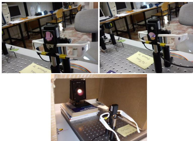
Figura 5.11: Calibración del fotodiodo usando Luxómetro y filtro dicróico
