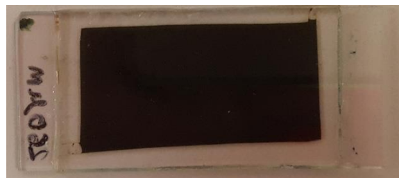
Figura 3.12. Cristal deteriorado tras aplicar 1,9V
