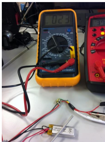
Figura I.13: Medida de la temperatura de las baterías.
