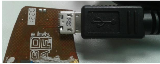
Figura I.3. Cable conexión al E8a
