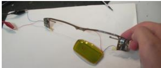
Figura 4.17. Verificación previa a ensambaldo de conmutación de un cristal.
