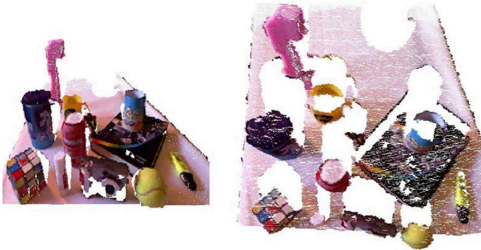
Figura 4.3: Ejemplo de una nube de puntos procedente de la Kinect: (izquierda) vista de las partes visibles de objetos del día a día, colocados encima de una mesa; (derecha) misma nube de puntos de la vista superior, donde los agujeros pertenecen a las partes y regiones ocultas.
