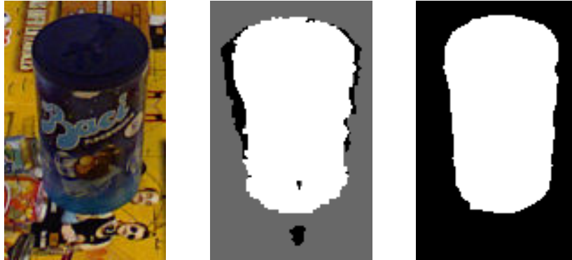
Figura 4.13: Ejemplo de segmentación refinada, incluso cuando el objeto de interés es similar al fondo. Izquierda: imagen en color, el objeto de interés es un frasco de almacenamiento encima de un póster. Medio: segmentación inicial. Los píxeles se marcan como: desconocido (negro), objeto (blanco) y fondo (gris). Derecha: segmentación final del objeto, después de GrabCut. Los píxeles se marcan como: objeto (blanco) y fondo (negro).
