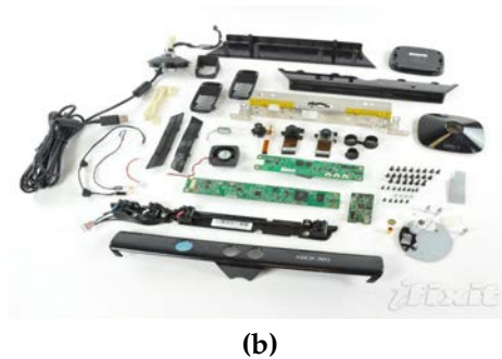
Figura 2.14: Cámara Kinect. (a) Elementos fundamentales. (b) Detalle de todos los elementos.
