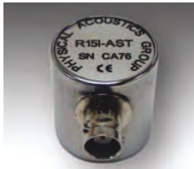
Figura 2.11. Transductor ultrasónico PZT, modelo R15I-AST.
