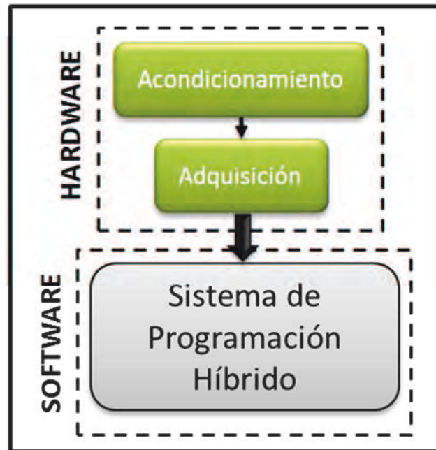
Figura 4.25. Sistema de adquisición multicanal con software de programación híbrido.
