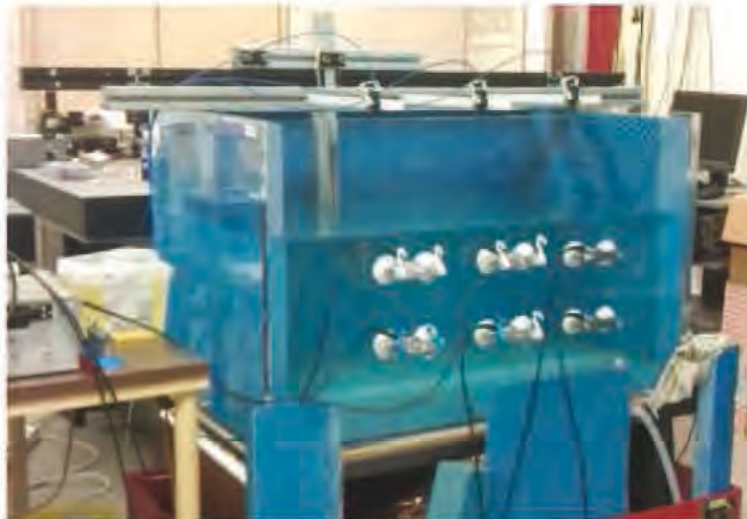
Figura 5.8. Detalle del experimento para la detección y localización de AEs.
