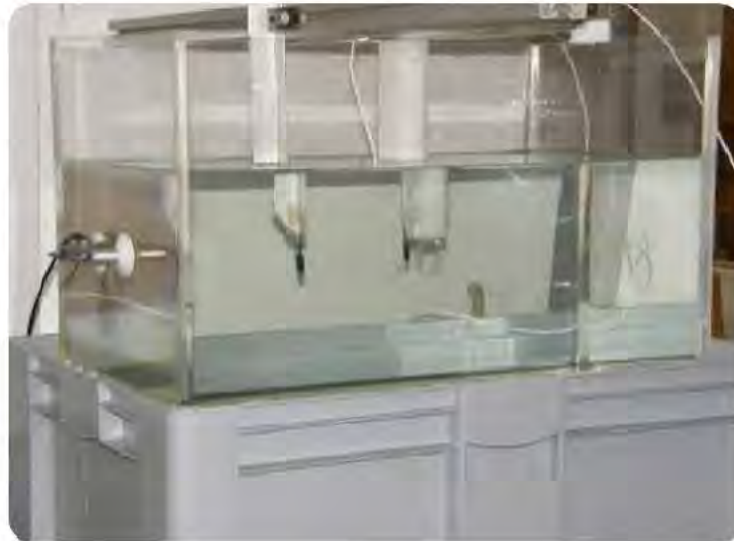
Figura 3.5. (a) Esquema de la configuración experimental utilizada para la caracterización de los sensores en la plataforma de ensayos acústicos en agua. (b) Detalle fotográfico de la plataforma de ensayos acústicos en agua.
