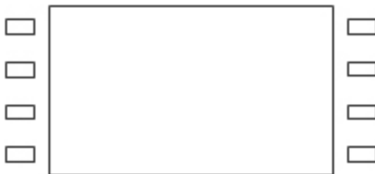
Figura 2 Fotograma de una película cinematográfica donde se observan 4 perforaciones laterales que permiten arrastrar la película. (Gráfico: Manuel Armenteros)
