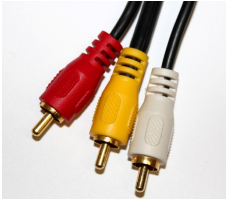
Figura 1 Conector RCA para transmitir señal de vídeo compuesto (amarillo) y audio estéreo. (Imagen: Juan Pedro Ramos)
