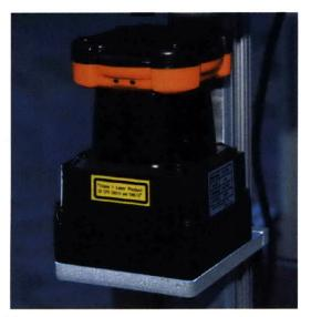
(d) UTM-30LX — 30m range, 270° FOV, 0.25° angular resolution, 40Hz update rate
