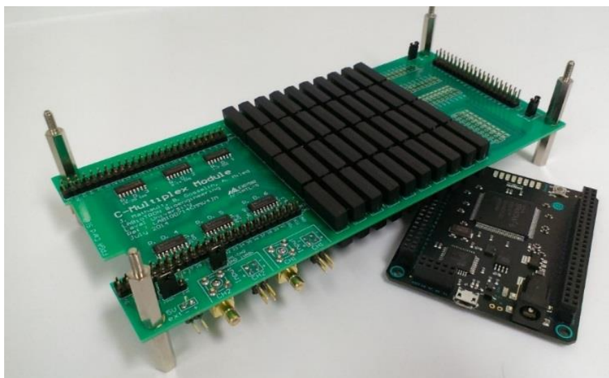
Figure 30 : Multiplexeur à 80 canaux de contrôles
