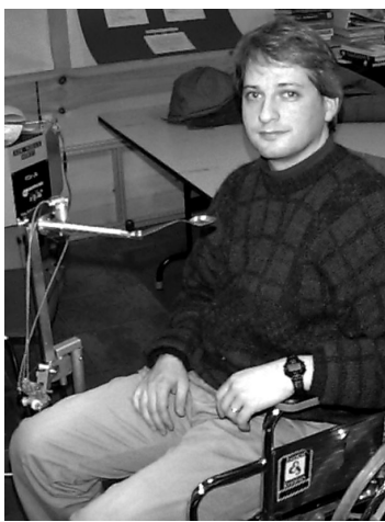
FIGURE 1.3 – Le Magpie sert d'aide à l'alimentation contrôlé par les déplacements d'une jambe de l'utilisateur via des câbles.
