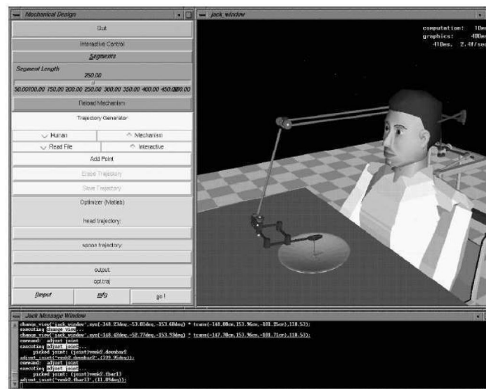
FIGURE 1.5 – Simulation du bras développé. Le contrôle se fait avec une partie du corps tel que la tête ou la jambe avec un second bras mécanique, qui déplace le bras avec la cuillère par un système de câbles et poulies.
