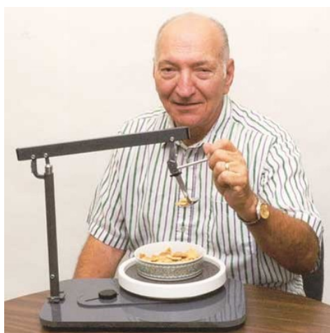
FIGURE 1.8 – Mécanisme d'amortissement des mouvements incoordonnés, le Comfy Feeder .
