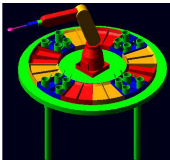
FIGURE 1.20 – Multiple-User Feeding Robot : Assistance permettant de faire manger quatre utilisateurs, ce qui permet d'optimiser le temps d'utilisation du robot lors de la mastication.
