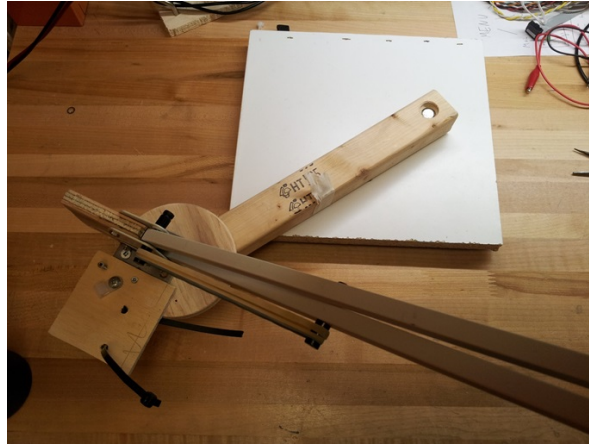
FIGURE 3.2 – Prototype préliminaire présentant un degré de liberté au niveau de la base, deux au niveau du coude et un quatrième au niveau de l’attache ustensile.
