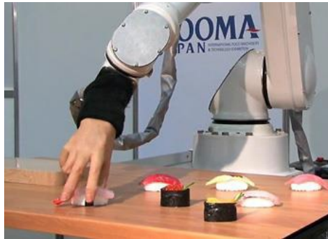
FIGURE 1.18 – Robot Squise qui permet de décaler de la nourriture fragile.
