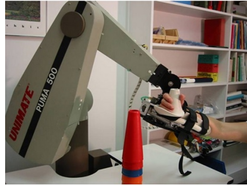
(b) Robot de réadaptation des muscles du bras Mirror Image Motion Enabler .
