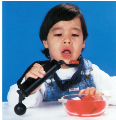
(b) Cuillère Steady Spoon qui maintient l'orientation de la cuillère à l'aide d'un mécanisme utilisant un contre-poids.
