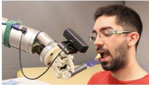
FIGURE 1.19 – Système robotique utilisant des capteurs pour localiser le visage de l'utilisateur afin de corriger la trajectoire de l'ustensile.
