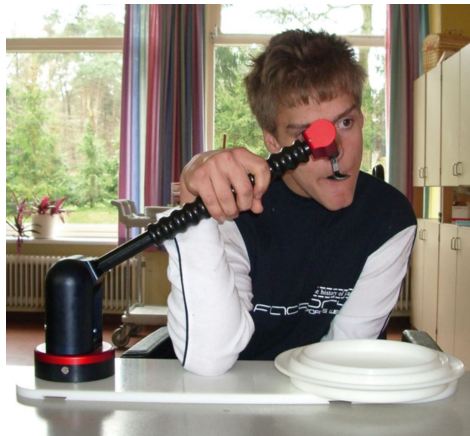
FIGURE 1.11 – Aide à l'alimentation Nelson qui guide et amorti les mouvements incoordonnés lors des mouvements du bras de l'utilisateur.
