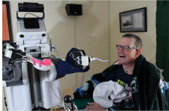
FIGURE 1.24 – Robot d'assistance personnelle PR2 pouvant manipuler divers objets et se déplacer.
