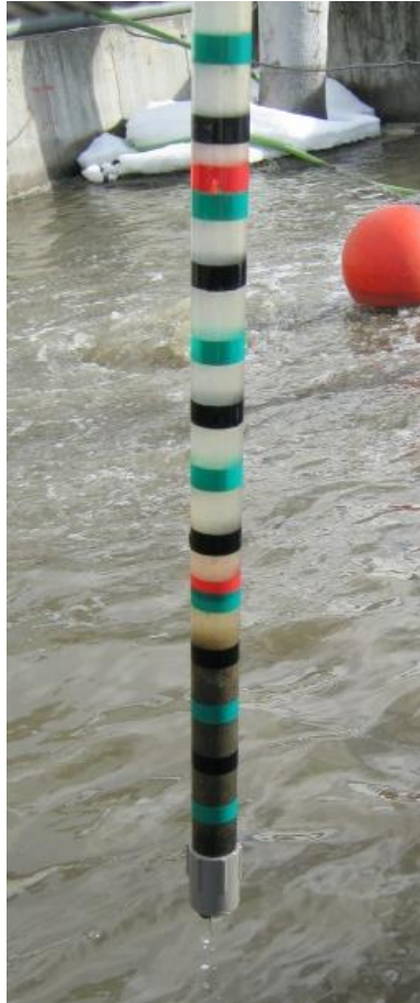
Figure 18 Jauge avec boues de fond et graduation à chaque 5 cm
