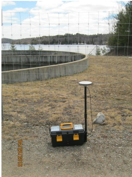
Figure 21 Récepteurs GPS utilisé comme station de référence sur le sol
