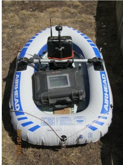
Figure 20 Récepteurs GPS sur l'embarcation allant sur l'étang
