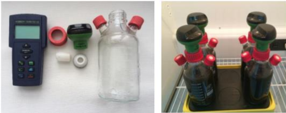
Figure 24 Ensemble Oxitop pour les tests PBM et SMA
