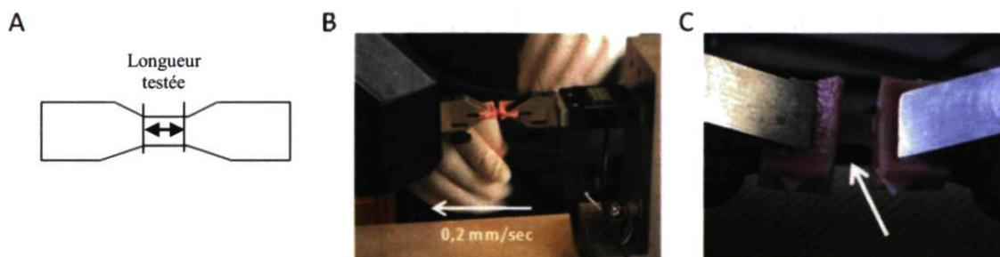
**Figure 2.4 :** Étapes effectuées lors du test de résistance mécanique. (A) Tissu coupé en languette pour le test de résistance. (B) Déplacement à vitesse constante de l'ancrage mobile (0,2 mm/seconde). (C) Déformation du tissu lors du test d'étirement uniaxial.
