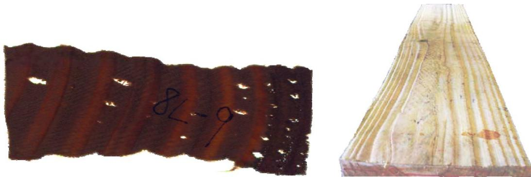
**Figure 1.20.** À gauche, face transversale d'une planche sciée sur quartier d'*Eucalyptus nitens* montrant le défaut de la planche à laver causé par le collapse et les gerces internes. À droite, vue d'une planche de la même espèce sciée sur dosse montrant le collapse sur ses bords (d'après Blakemore et Northway 2009).
