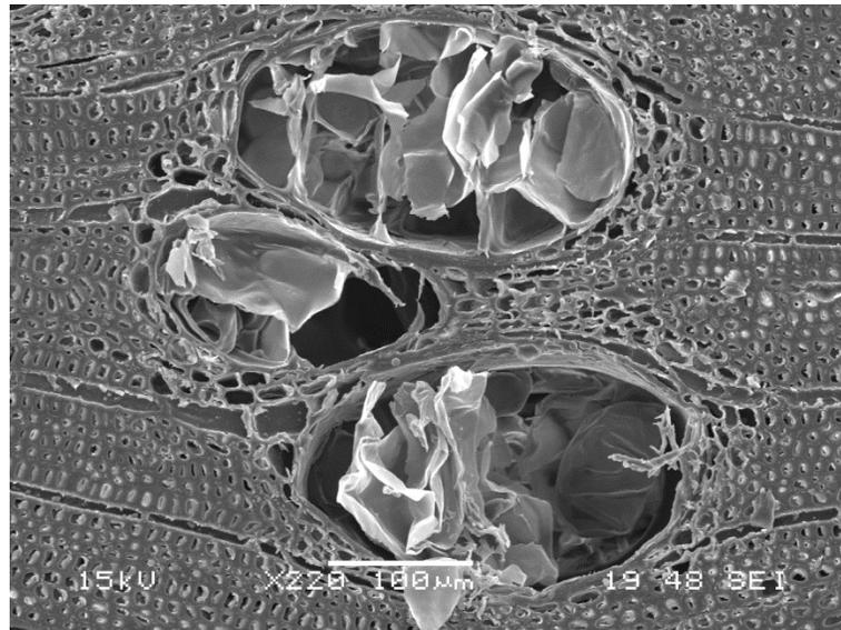
**Figure B.3.** Image d'une section transversale du bois d'*Eucalyptus saligna* obtenu par MEB (x220).
