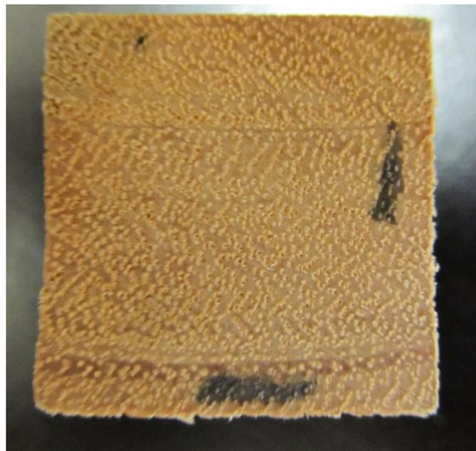
**Figure C.4.** Échantillon d'*Eucalyptus saligna* (groupe 4, 86% d'HR) montrant les effets du collapse observés au niveau macroscopique.
