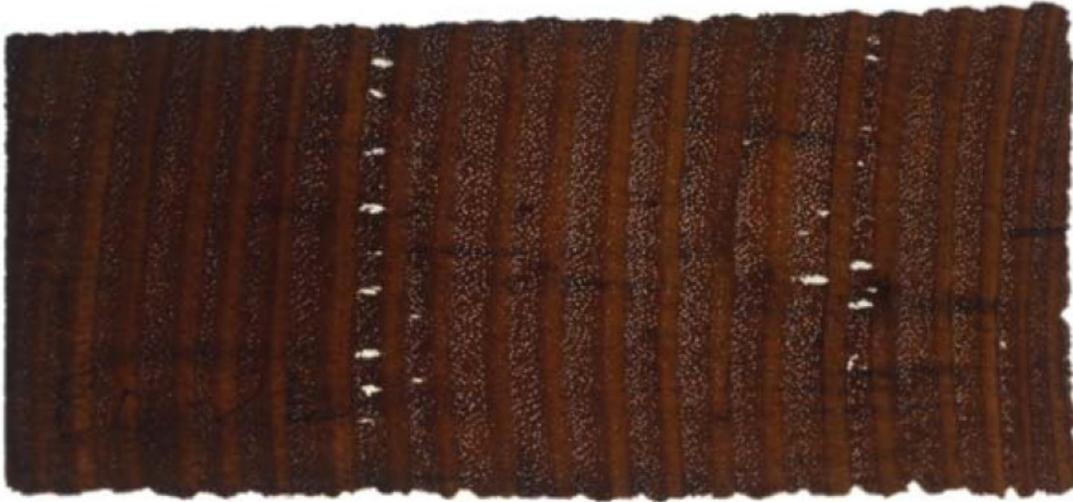
**Figure 1.21.** Gerces internes liées au collapse dans le bois initial d'*Eucalyptus* sp. (tiré de Blakemore et Northway 2009).
