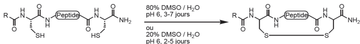
Figure 34. Schéma réactionnel de la cyclisation des ponts disulfures à l'aide du DMSO.
