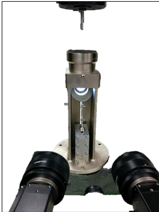
Figure 77 Photo du montage d'indentation quasi-statique
