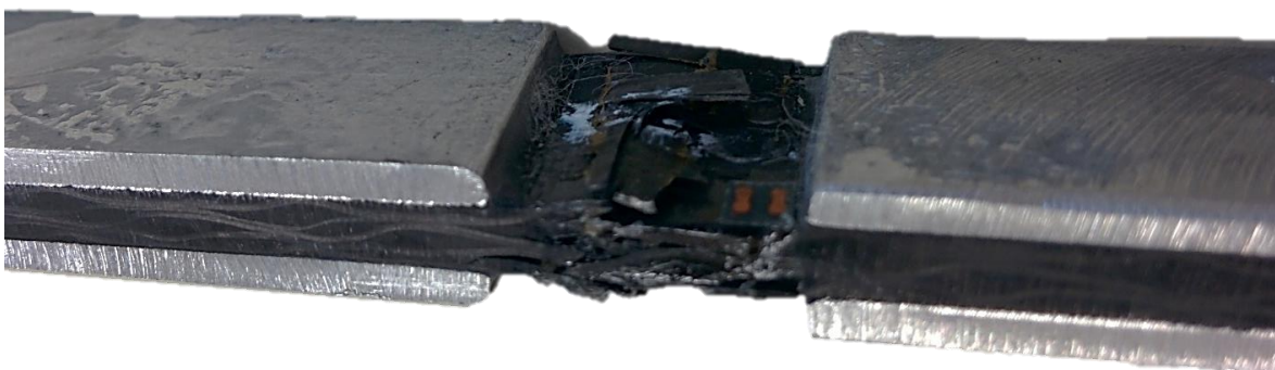
Figure 29 Profil de rupture de l'éprouvette n°3 en compression dans la direction chaîne
