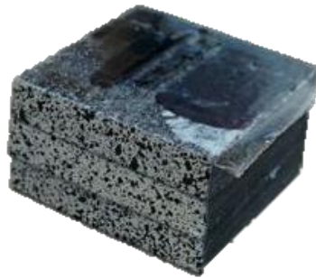
Figure 34 Éprouvette de compression à travers l'épaisseur
