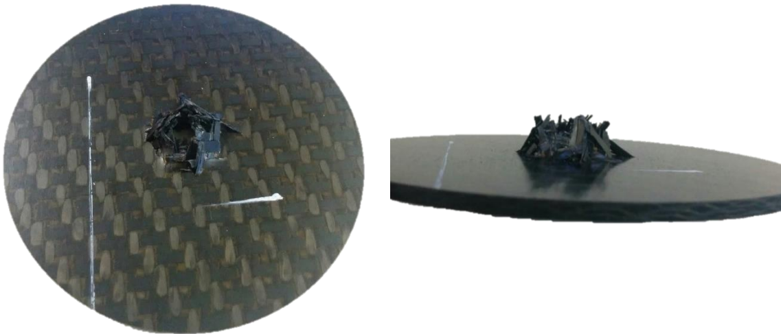
Figure 90 Photographies d'une éprouvette impactée à une énergie de 63 J
