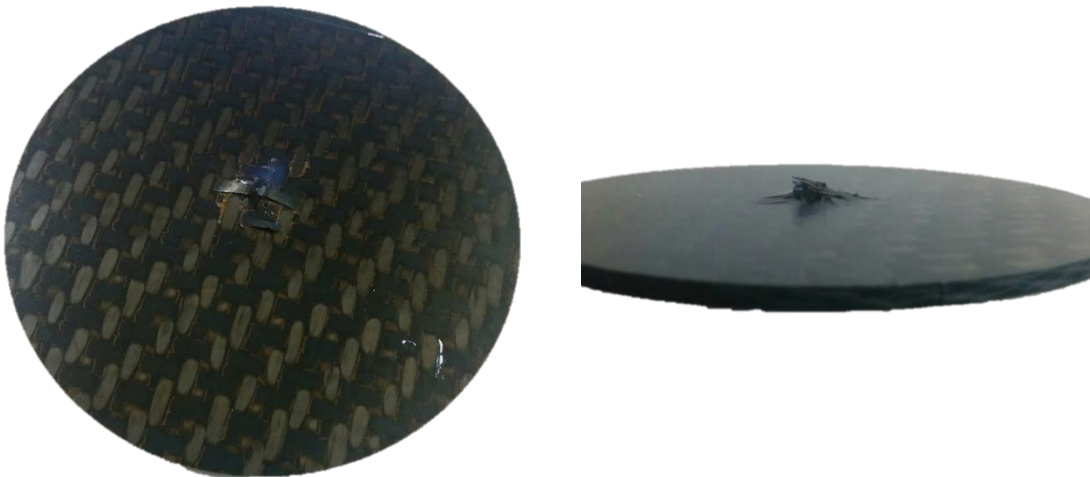
Figure 88 Photographies d'une éprouvette impactée avec une énergie de 20 J
