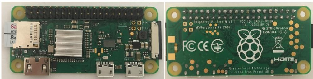
Figure 37 : Raspberry Pi Zero W.
