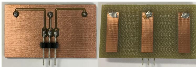
**Figure 21** : Électrodes avec pads en cuivre.
