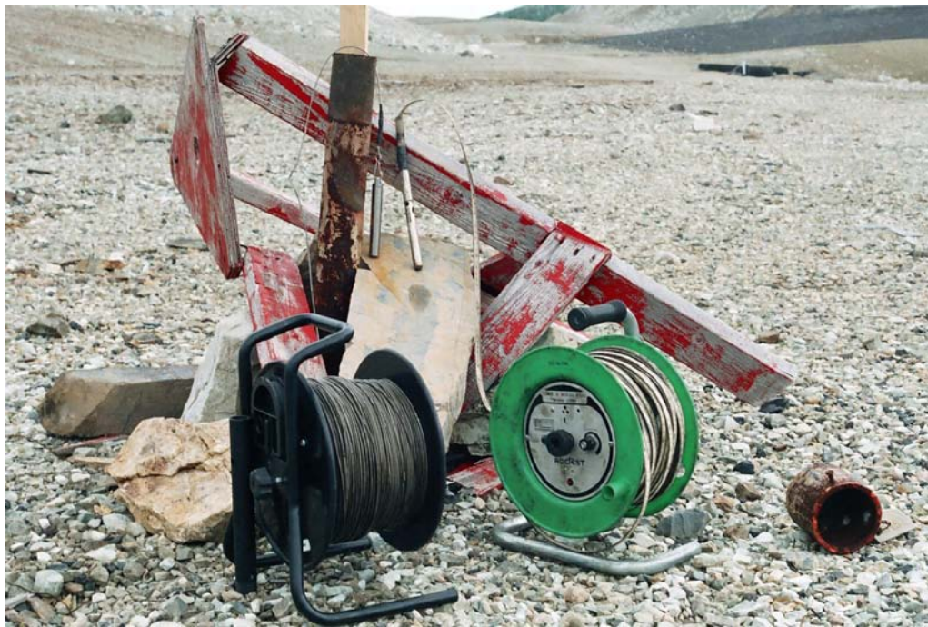
Photo 1. Instruments utilisés pour la mesure du niveau de l'eau et des profils de température.
