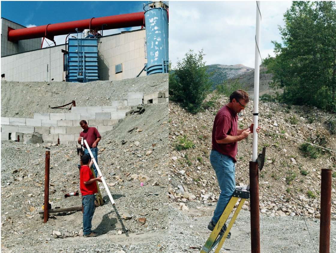
Photo 5 et 6. Descente de la caméra submersible dans l'ancien puits de ventilation 1100.
