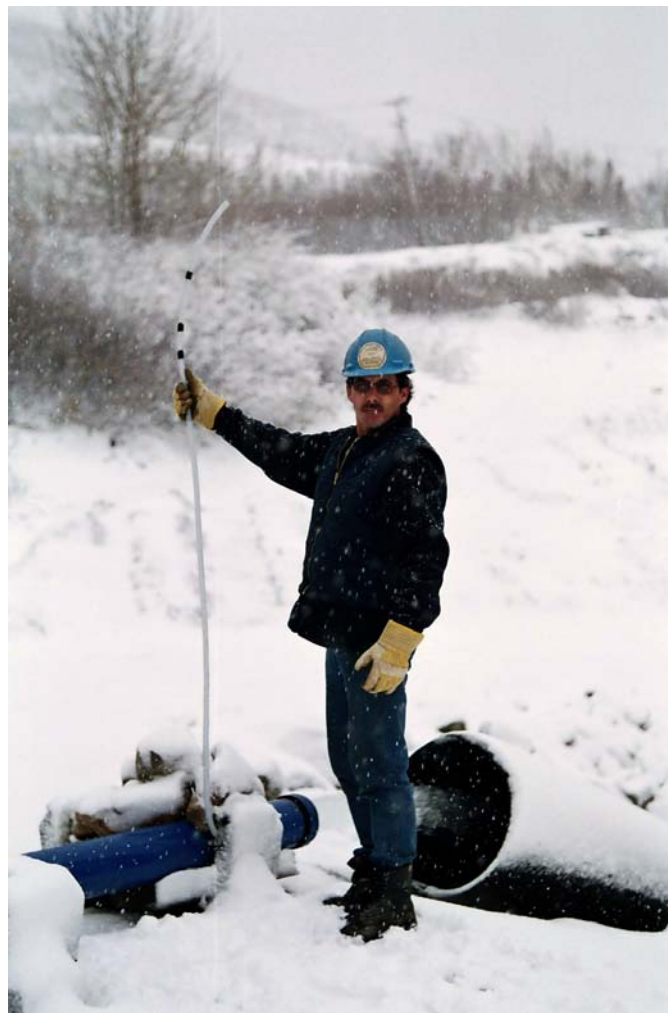
Photo 12. Mesure du débit d'eau pompée au compteur d'eau lors de l'essai de pompage.
