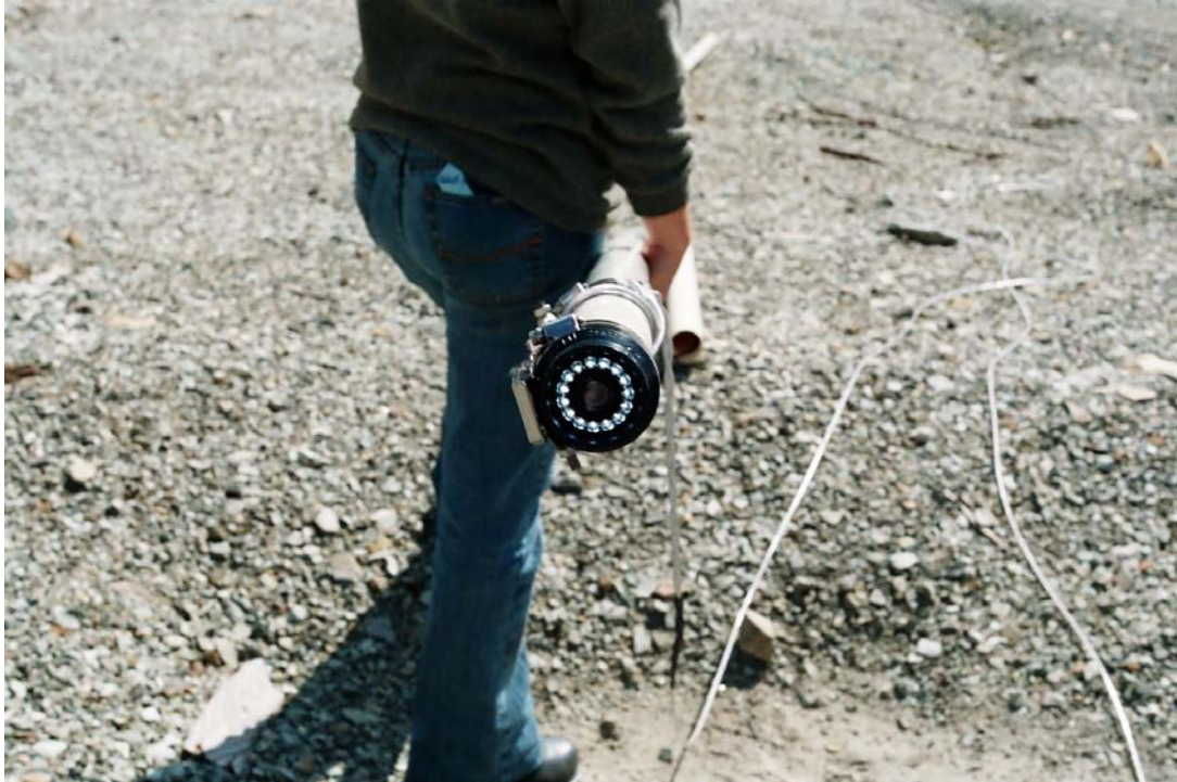
Photo 4. Tête de la caméra submersible.
