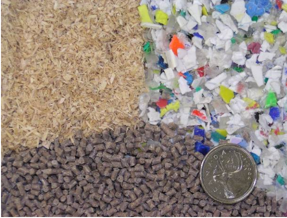
Figure 3.04. Fibres de bois, polymère recyclé et composite extrudé.
