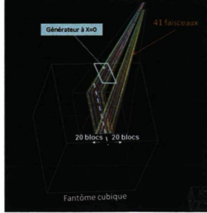
FIGURE 3.4 – Illustration en 3D des 41 sous-champs dans Pinnacle 3 , applicateur 25x25 cm 2 , X = 0 .
