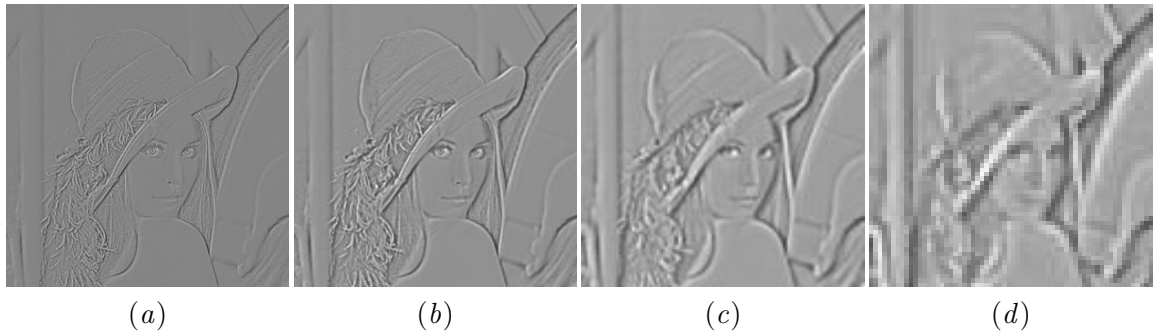
FIGURE 5.4 : Exemple de détails de ratios sur 4 niveaux pour l'image de Lenna ; (a) détails du niveau 0, (b) du niveau 1, (c) du niveau 2 et (d) du niveau 3.
