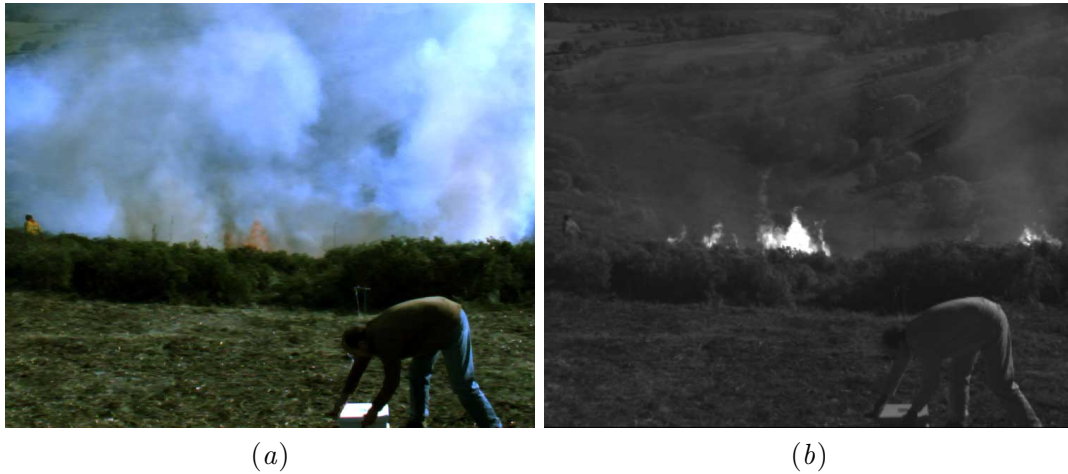
FIGURE 8.5 : Image multimodale obtenue lors du premier brûlage dirigé. (a) image du spectre visible et (b) Image du spectre proche-infrarouge.
