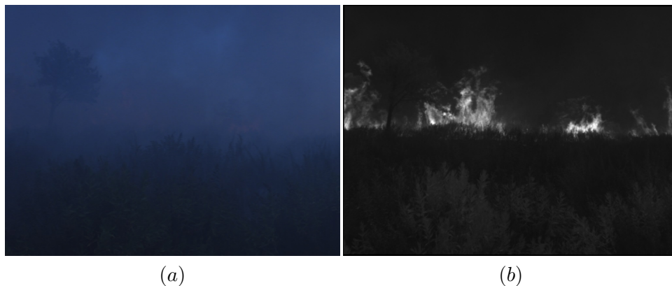
FIGURE 4.4 : Exemple de feu masqué par de la fumée dans des conditions réelles. Brûlage dirigé sur la commune de Solaro (Haute Corse) : (a) image acquise dans le spectre visible, (b) image acquise dans le spectre infrarouge.
