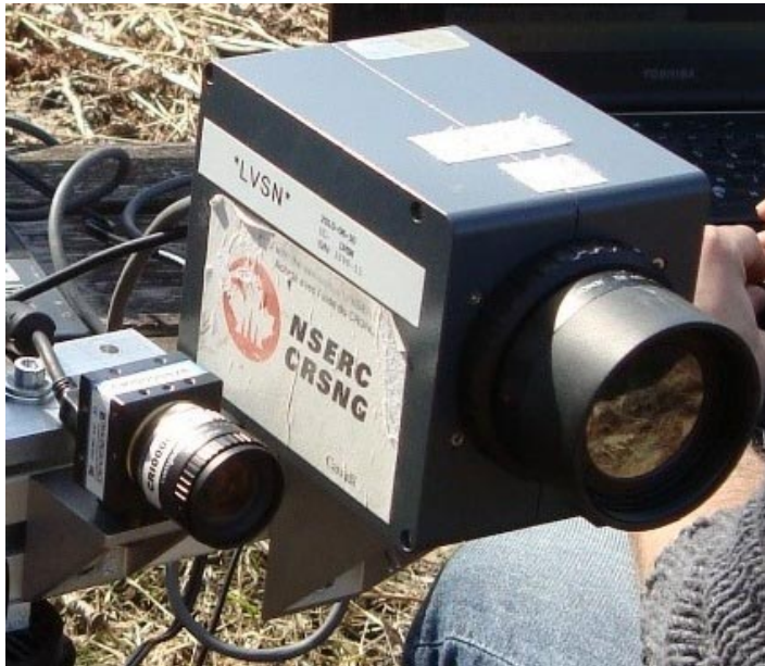
FIGURE 2.6 : Caméra DFK 72BUC02 (à gauche) et caméra IR-TCM 384 (à droite) fixées côte à côte sur un axe.
