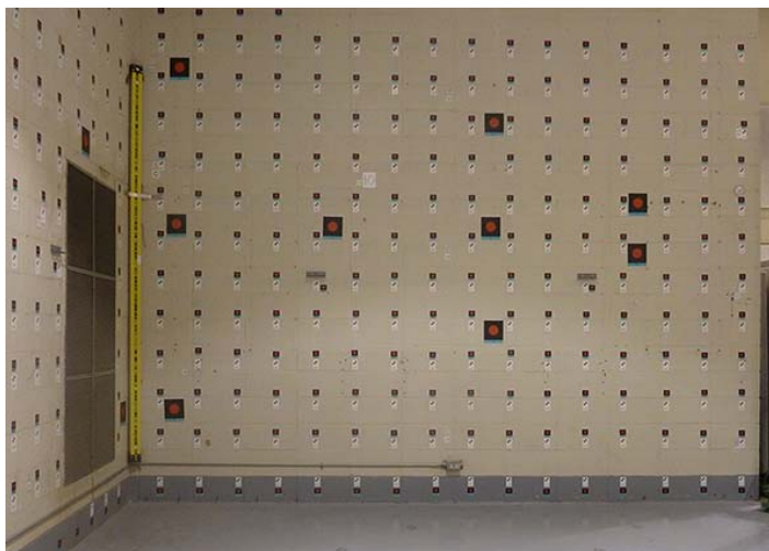
FIGURE 6.6 : Mur de la salle de métrologie. La position relative de chaque point est référencée.
