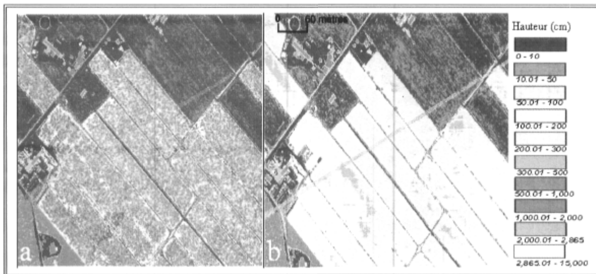
Figure 24 : Images générées à partir des nuages de points lidar : a; à partir de données fournies par le producteur des données, b; après interpolation de l'altitude de l'intérieur des parcelles à partir de leurs contours.
