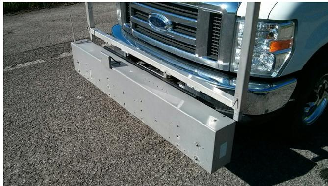
**Figure 22 : Profilomètre inertiel ICC©**
