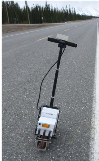
**Figure 23 : Profilomètre à basse vitesse SurPRO©**
