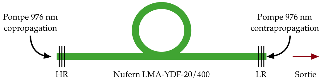
Figure 5.1 – Montage de simulation pour étudier l’effet de la variation des paramètres de la cavité laser sur l’instabilité Raman.
