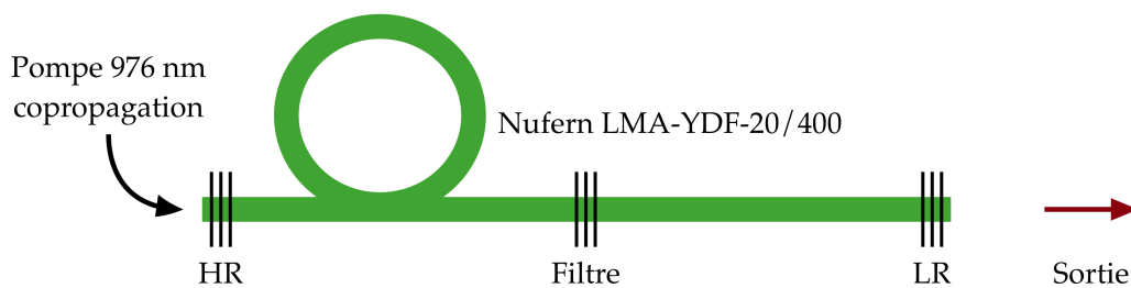
Figure 6.1 – Montage de simulation pour l'effet de la présence d'un filtre intracavité sur l'instabilité Raman.
