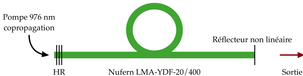
Figure 6.3 – Montage de simulation pour l’effet de la présence d’un réflecteur non linéaire sur l’instabilité Raman.
