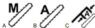
Figure A.1 : Symboles utilisés par le logiciel Log Mate 500 pour indiquer le degré d'automatisation A) manuel B) automatique C) semi-automatique
