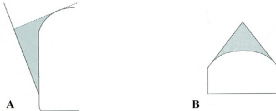
Figure 2.12 : (A) Instabilité structurale pouvant glisser (B) Instabilité structurale pouvant tomber sous l'effet de la gravité, modifiée de Hadjigeorgiou et Charrette (2009)
