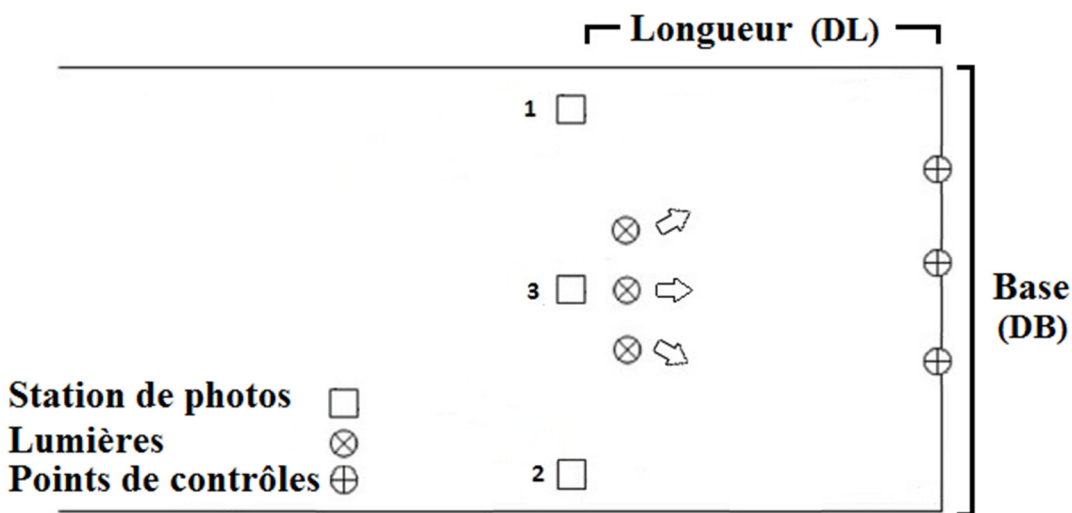
Figure 2.5 : Modèle adapté de prise de photos sous terre
