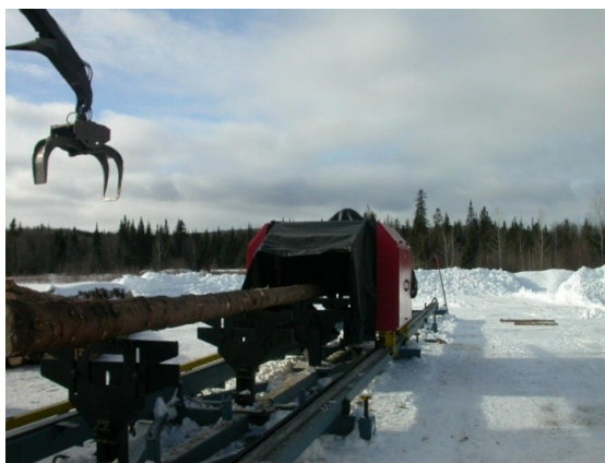
Figure 2.21. Scan tridimensionnel de la forme externe des tiges
