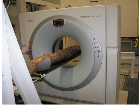
Figure 2.24. Scan des caractéristiques externes et internes des billes à l'aide du CT-Scan à rayons X
