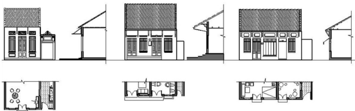
Figure 4.12. Type 2 de façade des maisons anciennes- Type.ANC.S-2.
