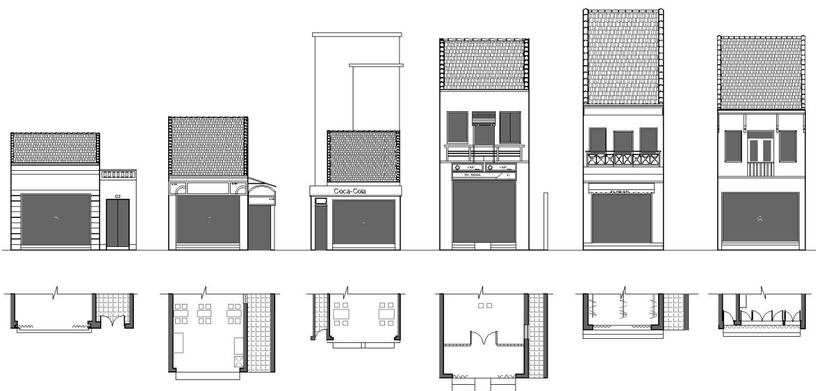
Figure 4.18. Type 2 de façade des maisons transformées- Type.TRF.F-2.
