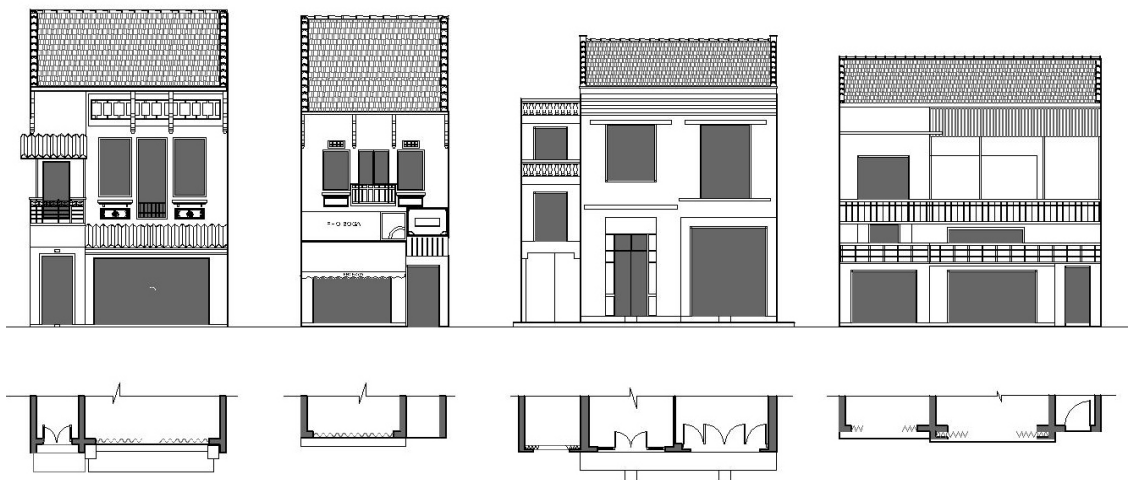
Figure 4.19. Type 3 de façade des maisons transformées- Type.TRF.F-3.
