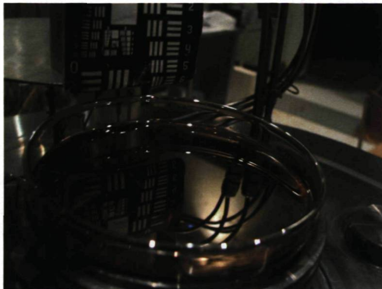
Figure 6.26 – Film d'argent déposé sur une couche intermédiaire d'aluminium. La couche intermédiaire a été déposée sur le liquide ionique en utilisant une source type F. La quantité d'aluminium évaporé était de 49.1 nm. Alors que celle de l'argent était de 35 nm. Ce dernier a été évaporé par une source type E.
