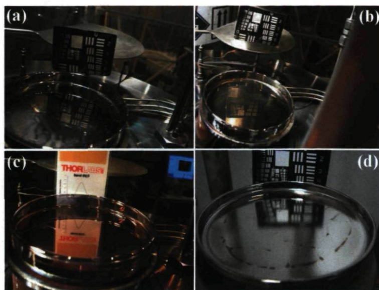
Figure 6.48 – Différents résultats obtenus lors de l'évaporation de l'argent sur un film de PEN. Le film de PEN a été déposé sur le liquide ionique avec une source type N.
