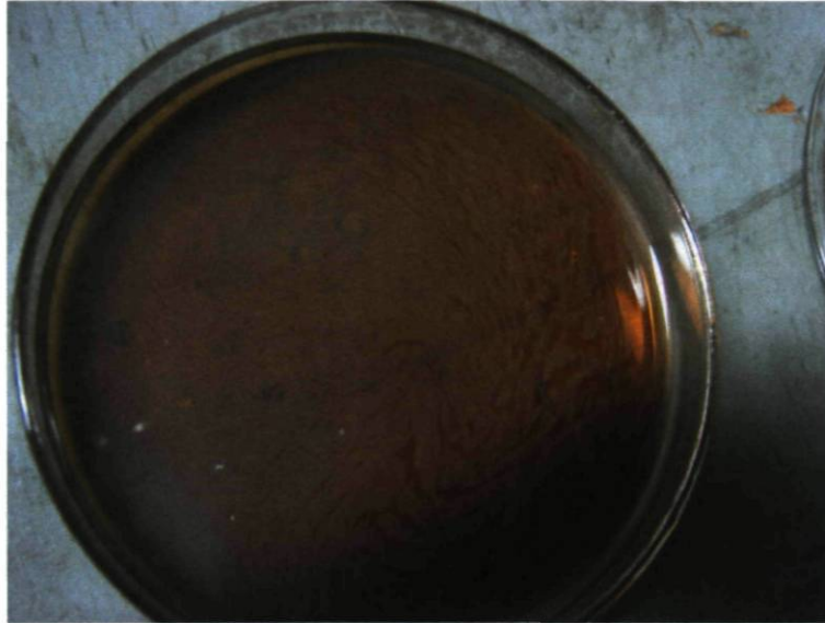
Figure 6.28 – Dépôt d'argent de 75.3 nm sur liquide ionique porté à la température de 430 K.
