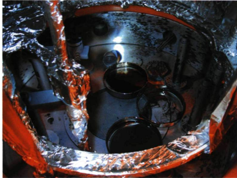
Figure 5.1 – Résultat de l'évaporation de l'aluminium sur trois fluides différents : du haut vers le bas respectivement, D705, huile silicone 1000 cSt et huile silicone 500 cSt.
