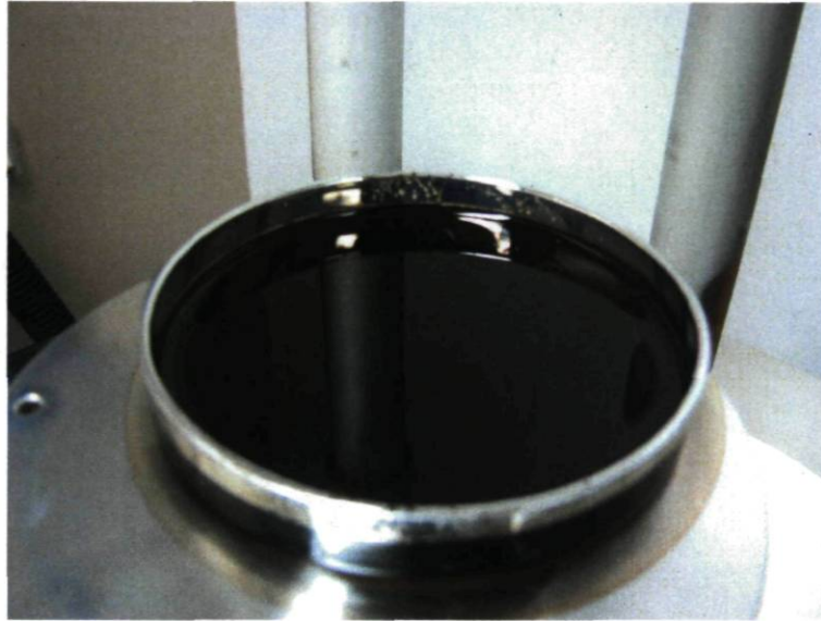
Figure 5.5 – Aluminium déposé par évaporation sous vide sur la FT705 (huile pour pompe à diffusion). Résultat : une mince pellicule couvre toute la surface du liquide.
