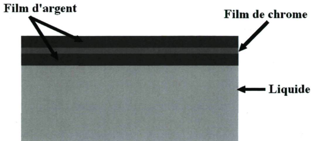
Figure 5.36 – Schéma décrivant la procédure de dépôt de film en trois couches sur un liquide.
