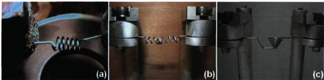
Figure 4.11 – Les différentes sources filaires utilisées dans les expériences de métallisation : (a) source filaire modifiée ou type B, (b) source filaire Type A, (c) source filaire Type F.
