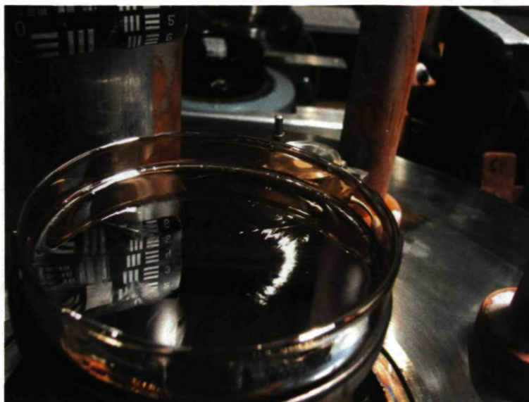
Figure 6.38 – Film d'argent réalisé par l'évaporation de 30 nm d'argent sur un dépôt de SiO. Ce dernier a été réalisé par l'évaporation de 21 nm de SiO sur le liquide ionique.
