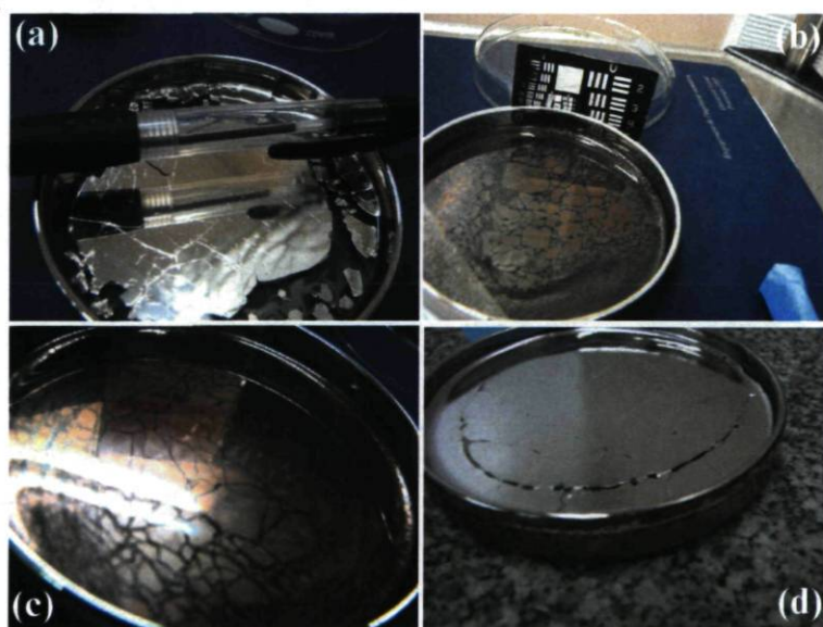
Figure 6.49 – Aspect des dépôts de la figure 6.48 après leur déplacement. Cela montre les deux type de film obtenus : le type solide, cas des dépôts (a) et (d) ; le type fragile, cas des dépôts (b) et (c).
