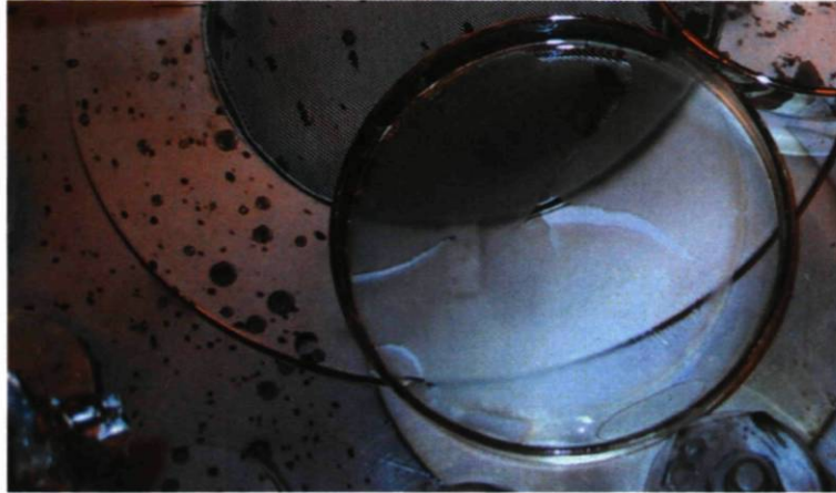
Figure 5.9 – Résultat de l'évaporation de l'aluminium sur l'huile silicone avec une faible vitesse d'évaporation. L'interaction de l'aluminium avec la surface a donné lieu à la formation d'une mince couche gélatineuse semi-transparente.
