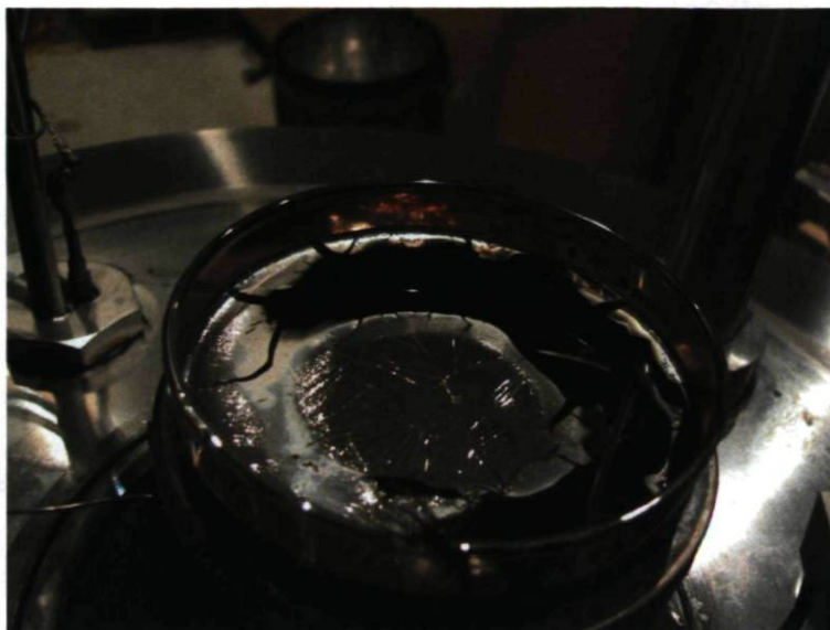
Figure 6.29 – Dépôt d'une quantité d'argent de 75.9 nm sur une fine couche de liquide ionique (moins de 3 mm d'épaisseur). Le liquide a été chauffé avant la métallisation. Celle-ci avait eu lieu lorsque la température du liquide a baissé pour atteindre 291 K.
