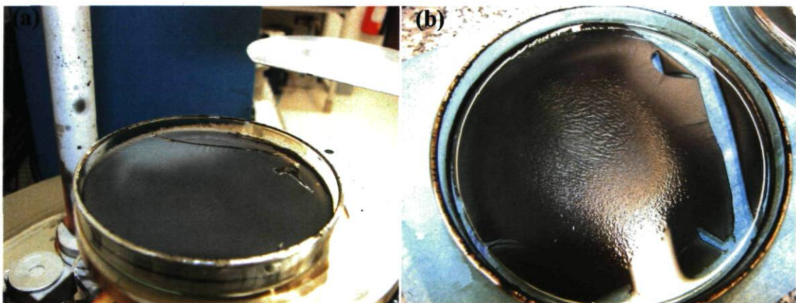
Figure 5.3 – Film d'aluminium déposé sur huile silicone 500 cSt : (a) photo prise après quelques minutes de la fin de l'évaporation ; (b) photo prise 20 heures après la fin de l'évaporation, on voit qu'une bonne partie de la surface du film est couverte de liquide.
