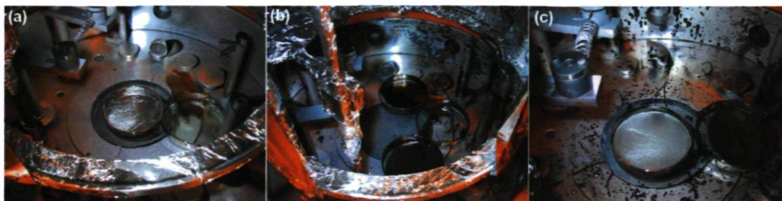
Figure 4.1 – Aggravation de la contamination du système à vide de la salle blanche à mesure que les travaux de recherche se poursuivaient. L'ordre chronologique va de (a) vers (c).
