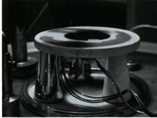
Figure 4.18 – Élément chauffant en forme de beigne installé sur trois supports en céramique pour assurer son isolation thermique. L'ensemble est placé à l'intérieur de la chambre à vide. Les fils qui ramènent le courant électrique depuis une alimentation à l'extérieur de la chambre sont connectés à deux orifices d'amenées (feedthrough) placés sur la base métallique de la cloche.
