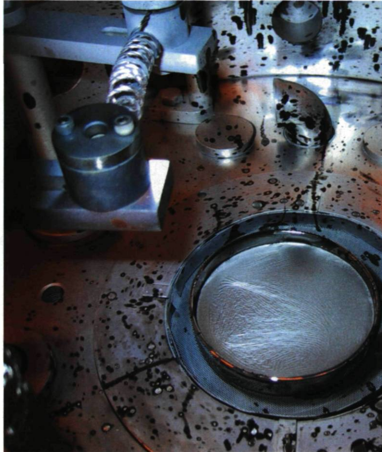
Figure 5.2 – Résultat de l'évaporation de l'aluminium sur huile silicone 500 cSt. On voit que le film obtenu n'est pas réfléchissant et, de plus, il est couvert de plissures observables à l'œil nu.
