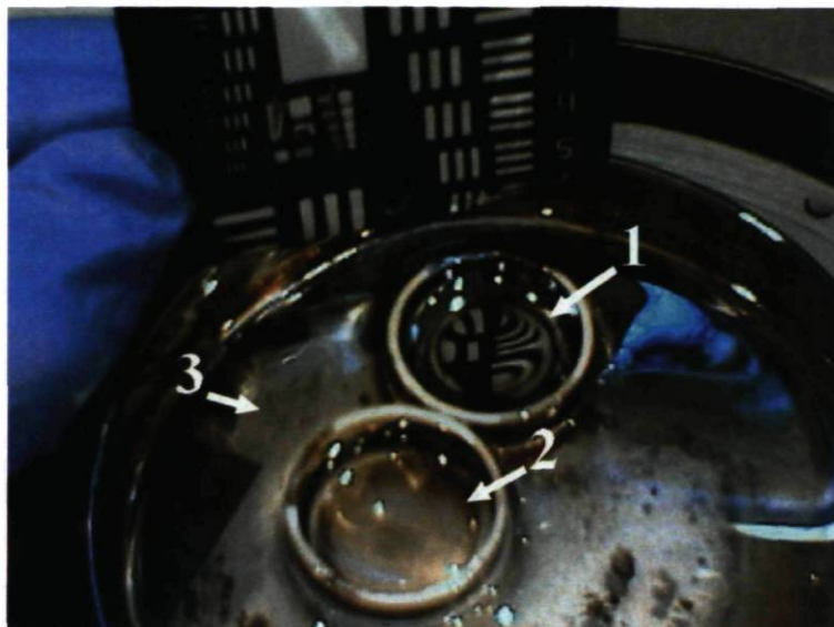
Figure 5.39 – Dépôt d'un film d'argent simultanément sur trois liquides : (1) liquide polymère hydrophile, (2) liquide polymère hydrophobe, (3) Santovac 5. Un film réfléchissant a été obtenu uniquement sur le liquide hydrophile.
