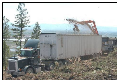
Figure 57 : Camion à copeaux 91,75 m 3 (53 pieds = 16,15 m) (USDA, 2005).
