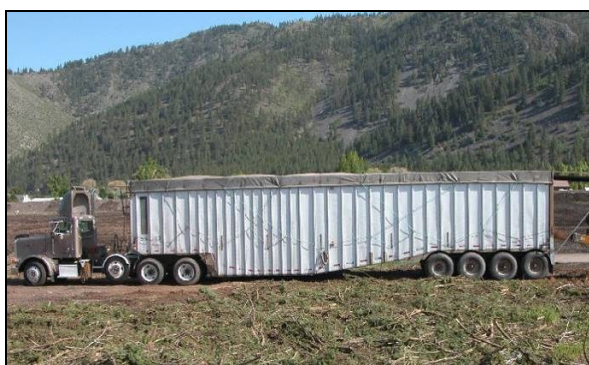
Figure 58 : Camion à copeaux 113,15 m 3 (USDA, 2005).
