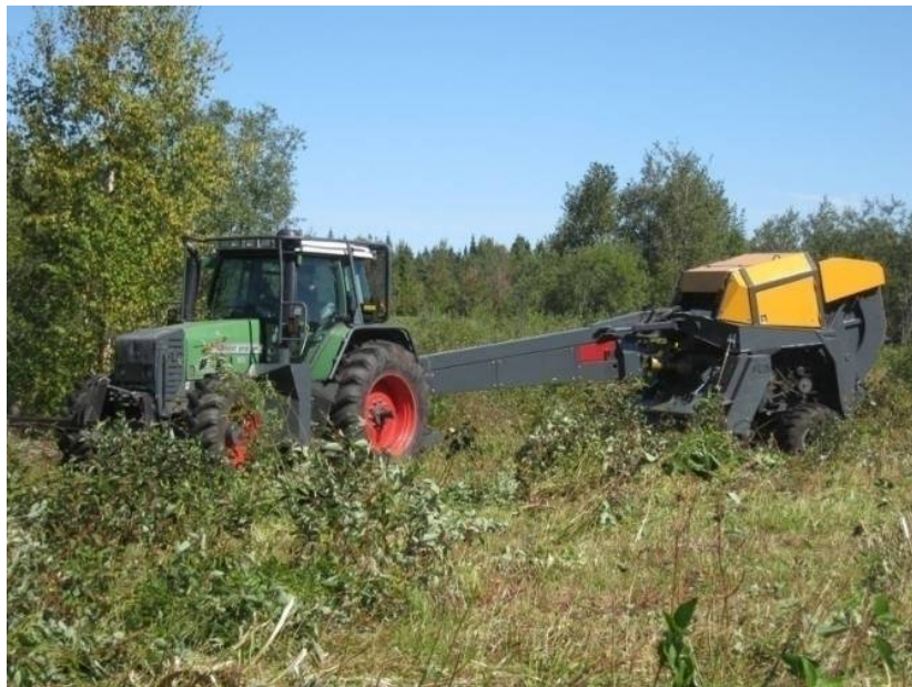
Figure 1 : Biobaler ® WB-55 et tracteur Fendt ™ 818 de 150kW (185 hp).
