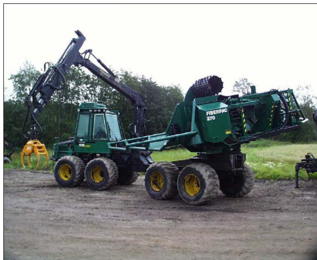
Figure 2 : Le Fiberpac bundler (FP 370 TM ) attaché sur le TJ-1210B TM (Johansson et al., 2006).
