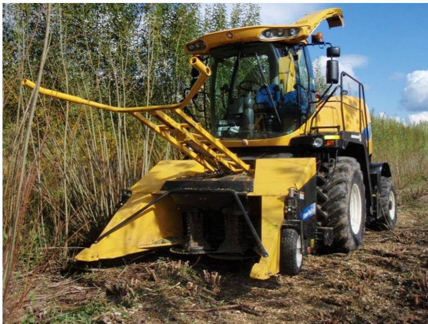
Figure 4 : Fourragère automotrice New Holland™ FR9060 avec une tête de récolte 130 FB.
