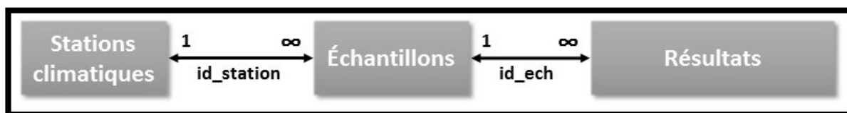
Figure 2.9. Schéma du modèle logique pour la BDIC. Les rectangles représentent les entités; le « 1 » et le « ∞ » représentent le lien de un (1) à plusieurs (∞) entre les entités, respectivement; et le nom sous les liens représente le nom de l'attribut qui lie les entités entre elles.
