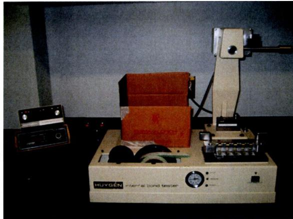
**Figure D.7 : Banc d'essai « scott bond »**
