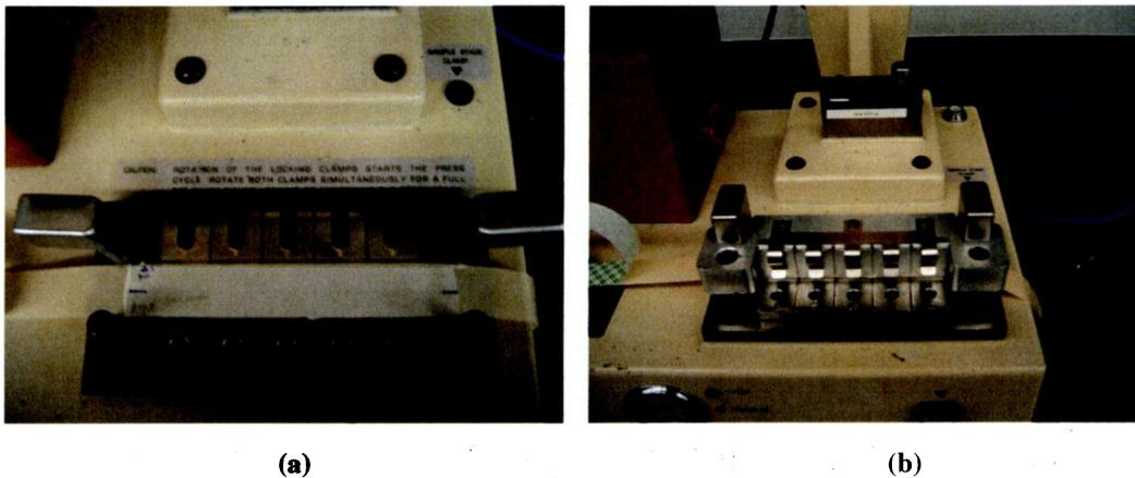
**Figure D.8 : Essai scott bond – Installation de la bande papier sur le support inférieur (a) et application de la pression (b)**
