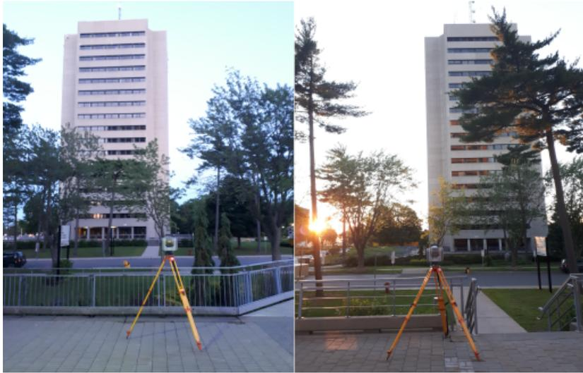
FIGURE E.12 – Acquisition des données lidar avec la SX10 au site 3. À gauche, station à la tour nord et à droite station à la tour sud
