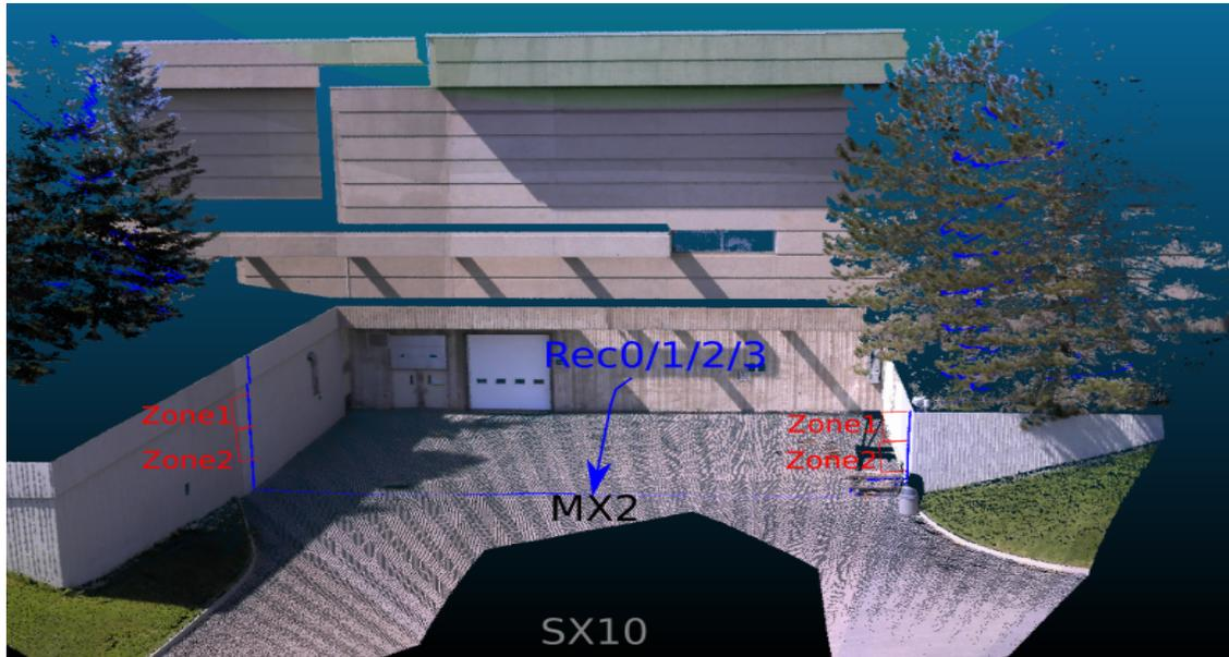
FIGURE 3.34 – Zone d'extraction des données lidar pour la série 2
