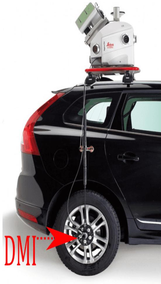
FIGURE 1.4 – Odomètre aidant au système de navigation du SLM terrestre
