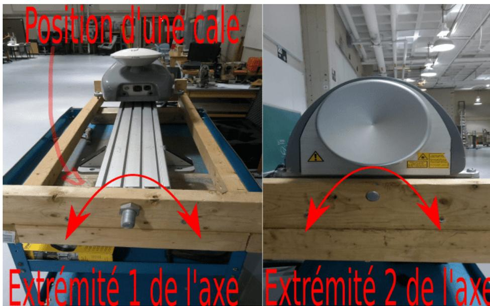
FIGURE E.7 – Montage mécanique : cadre pour rotation angulaire en roulis
