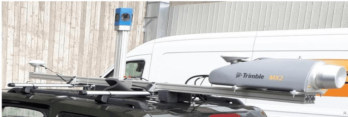
FIGURE 3.6 – Système lidar mobile Trimble MX2 *single head* monté sur le rack installé sur le toit d'un véhicule.
