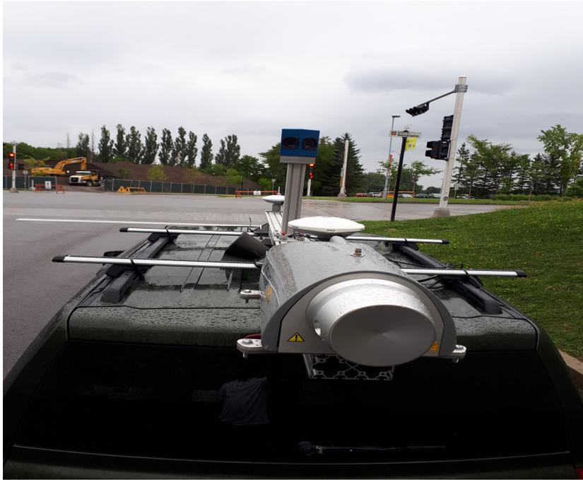
FIGURE E.10 – MX2 + G360 montés sur le rack du véhicule
