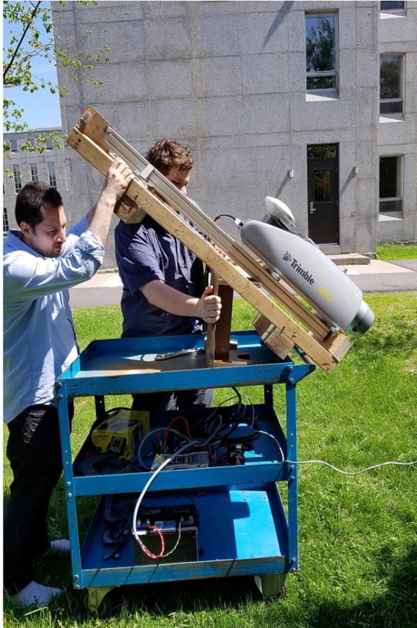
FIGURE 5.13 – Procédure fastidieuse d’acquisition pour l’ajustage des angles de visée.
