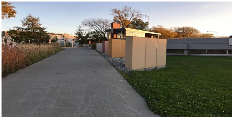
FIGURE 3.5 – Site 4 : plans servants à détecter la latence POS-lidar situés sur la rue de la Terrasse. Ces plans seront scannés à différentes vitesses. Un chariot sera utilisé, car le site est inaccessible en voiture.
