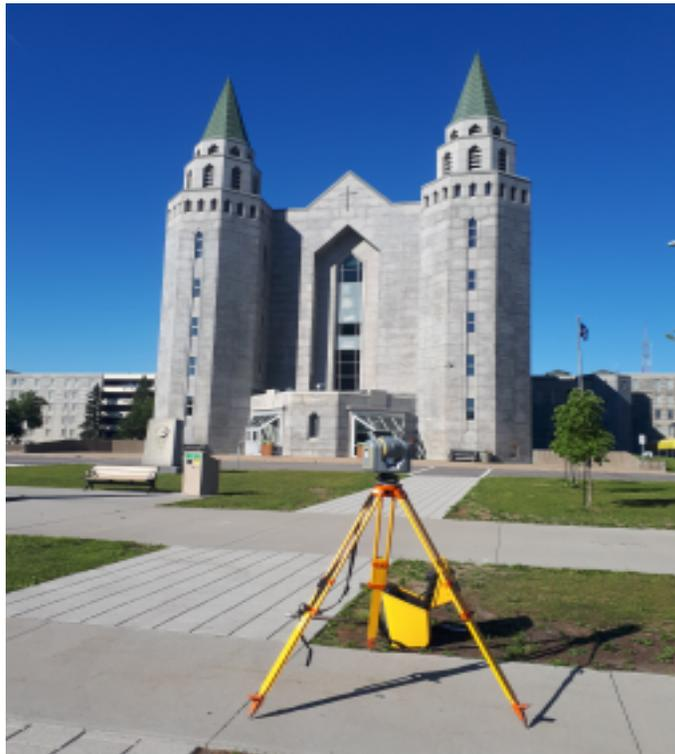
FIGURE E.13 – Station UL 1604, acquisition des données lidar avec la SX10 au site 1
