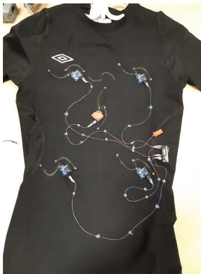
FIGURE 1.11 – Le chandail proposé : version à plusieurs capteurs
