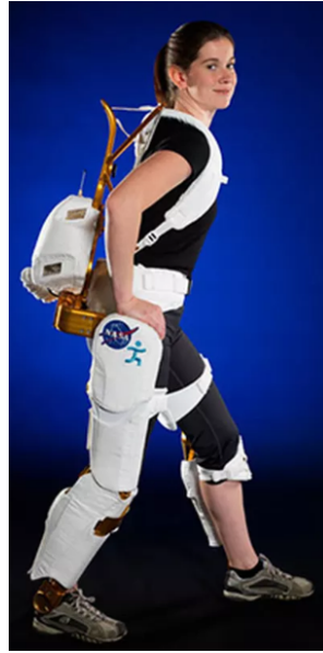
FIGURE 1.6 – L'exo-squelette X1 utilisé pour entrainer les futures astronautes pour protéger les muscles de la microgravité [18]
