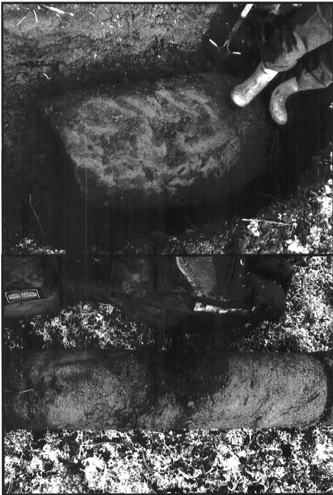
Figure 11 Pergélisol extrait de la tourbe (en haut) et carotte extraite à l'aide de la foreuse (en bas). À remarquer le faible contenu en glace du pergélisol.
