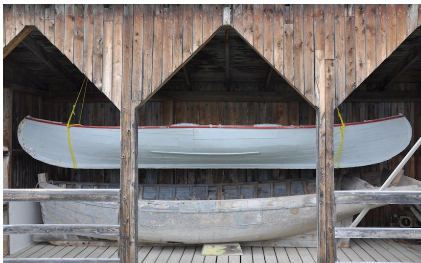
Figure 5 : Canot pour traverse sur la glace (au centre), en bois massif, une embarcation centenaire, présent au Centre d'interprétation du village Notre-Dame-des-Sept-Douleurs sur l'Île-Verte (Photo de Maude Tremblay 2012).
