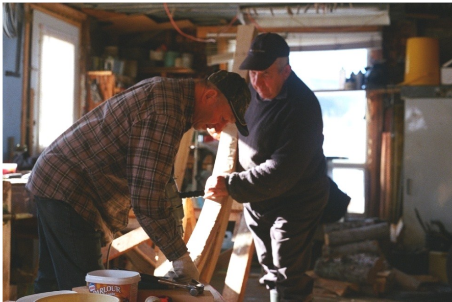
Figure 15 : Jean-Baptiste Caron et Gaston Poirier en train de poser l'étrave d'un flat à St-Yvon. (Photo de Mathieu Parent 2012)
