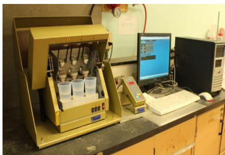
**Figure 2.4 Appareil pour la fusion boratée**
