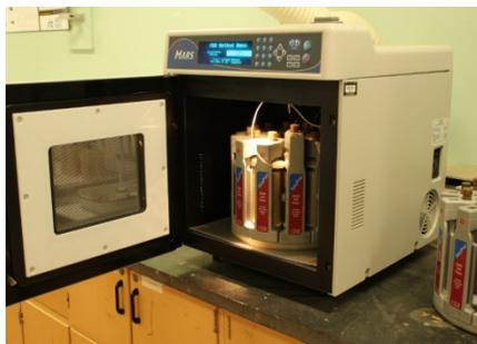
**Figure 2.2 Appareil pour la digestion micro-ondes**
