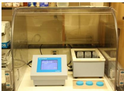
**Figure 2.1 Appareil pour la digestion sur plaque chauffante**
